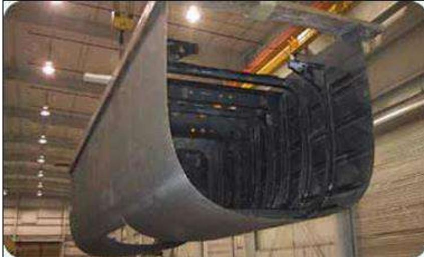
**Figura 7: Fuselagem de helicóptero. [Seeman Composites Inc].**
