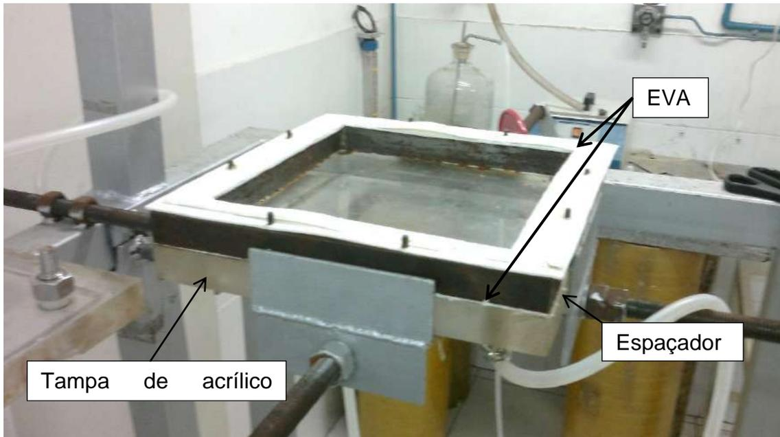
**Figura 37: Montagem do molde.**
