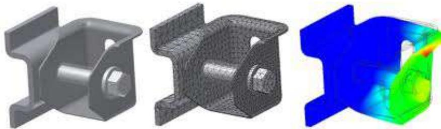
Figura 2.2: Etapas de simulação de uma peça mecânica: geometria, malha e curva de contorno, respectivamente. Fonte: Autodesk WikiHelp
