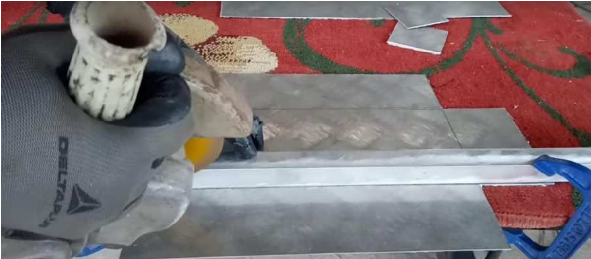
Figura 133 - Corte a 90° com rebaixo. Fonte: https://www.youtube.com/watch?v=5IfZGZRFIII
