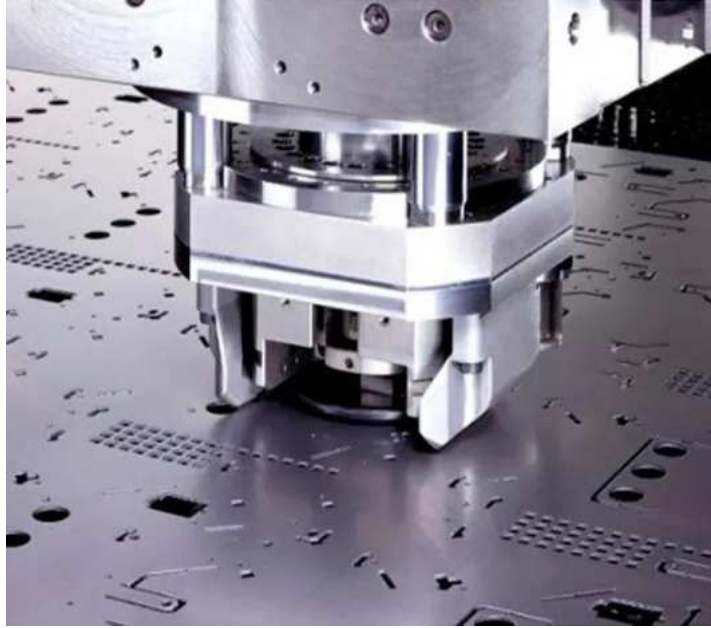
Figura 131 - Corte por puncionadeira. Fonte: https://www.portinari metalurgica.com.br/corte-puncionadeira.php
