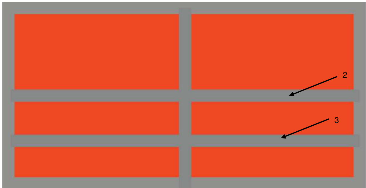
Figura 113 - Estrutura da comporta em vãos maiores. Fonte: Elaboração própria.
