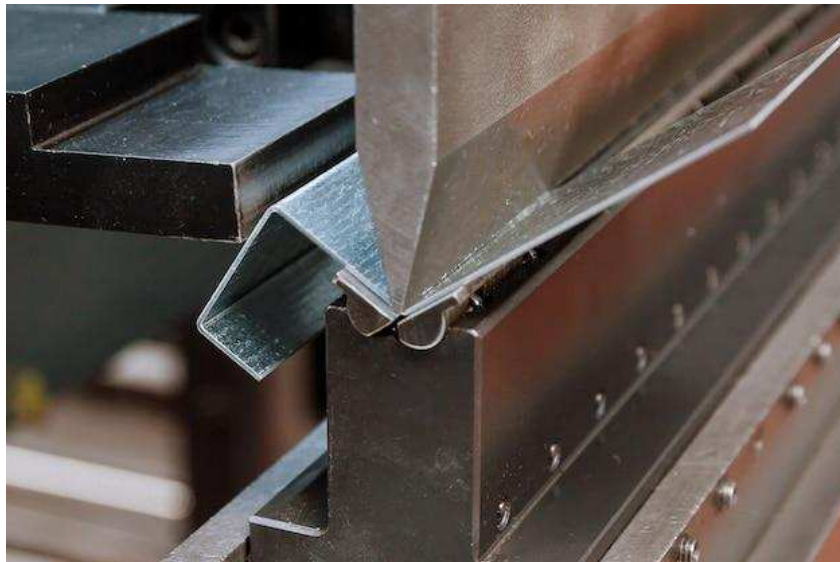
Figura 132 - Trabalho com dobradeira de chapas. Fonte: https://br.freepik.com/fotos-premium/trabalho-com-chapas-e-dobradeiras-especiais-prensa-dobradeira-hidraulica-ou-dobradeira-para-chapas-de-metal_15349344.htm
