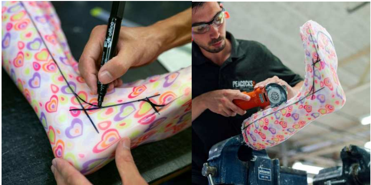
Figuras 15 e 16: Etapa de corte do termoplástico moldado na produção da órtese termoplástica de alta temperatura. Fonte: https://unsplash.com/pt-br/@thisengineering
