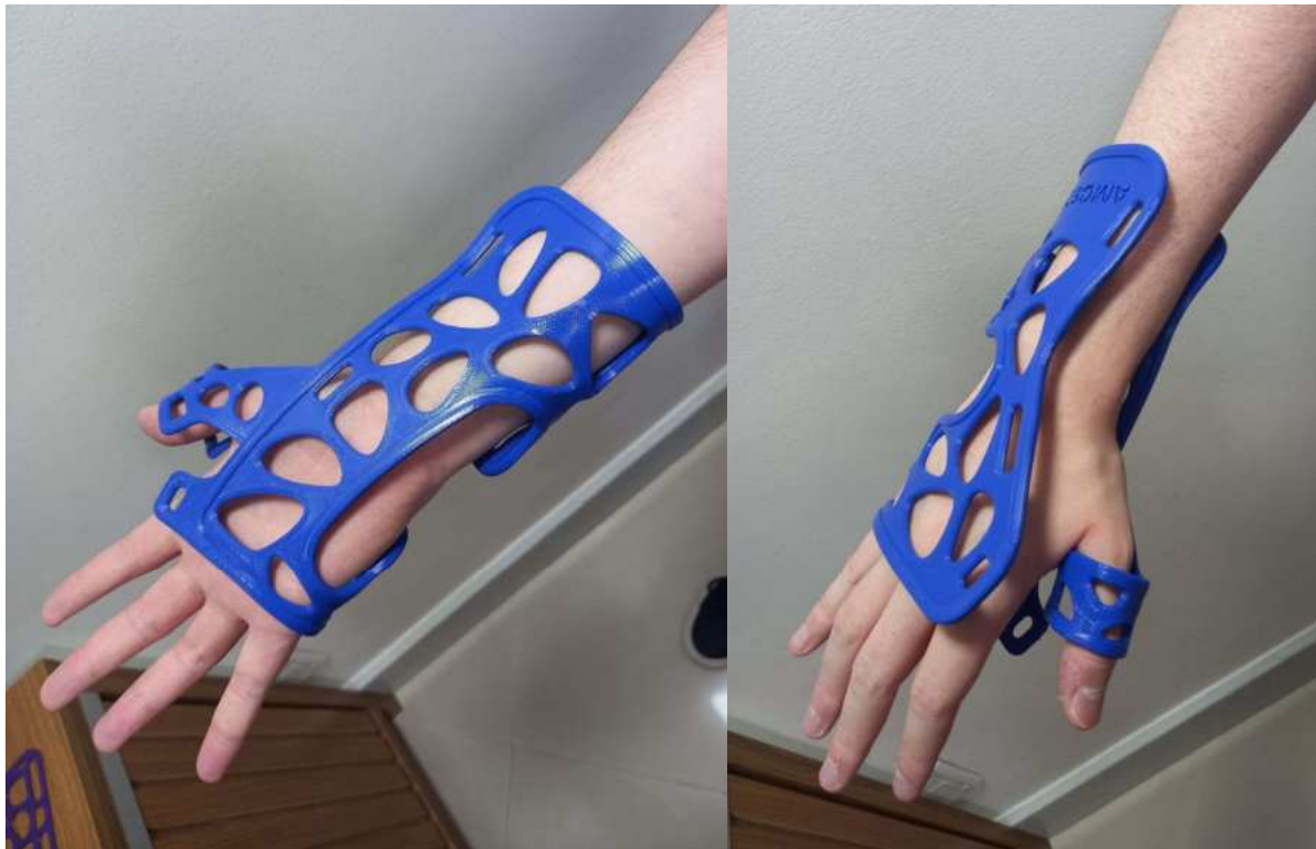
Figuras 25 e 26: Órtese impressa em 3D e moldada na clínica da CREB. Fonte: Autoria própria
