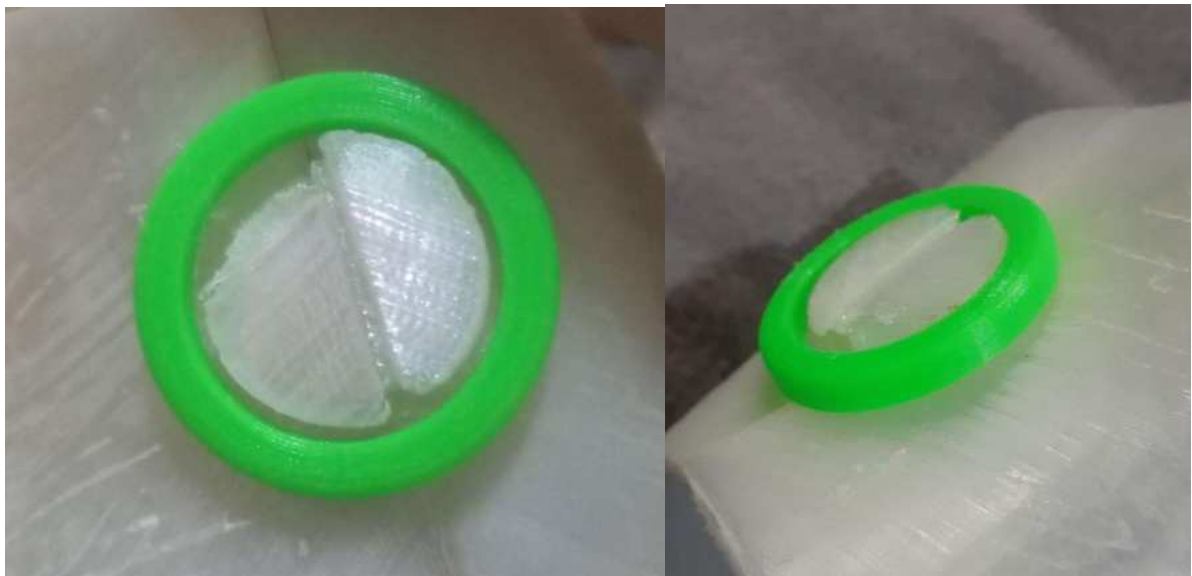
Figuras 104 e 105: Teste para fechamento de encaixes com TPU. Fonte: Autoria própria
