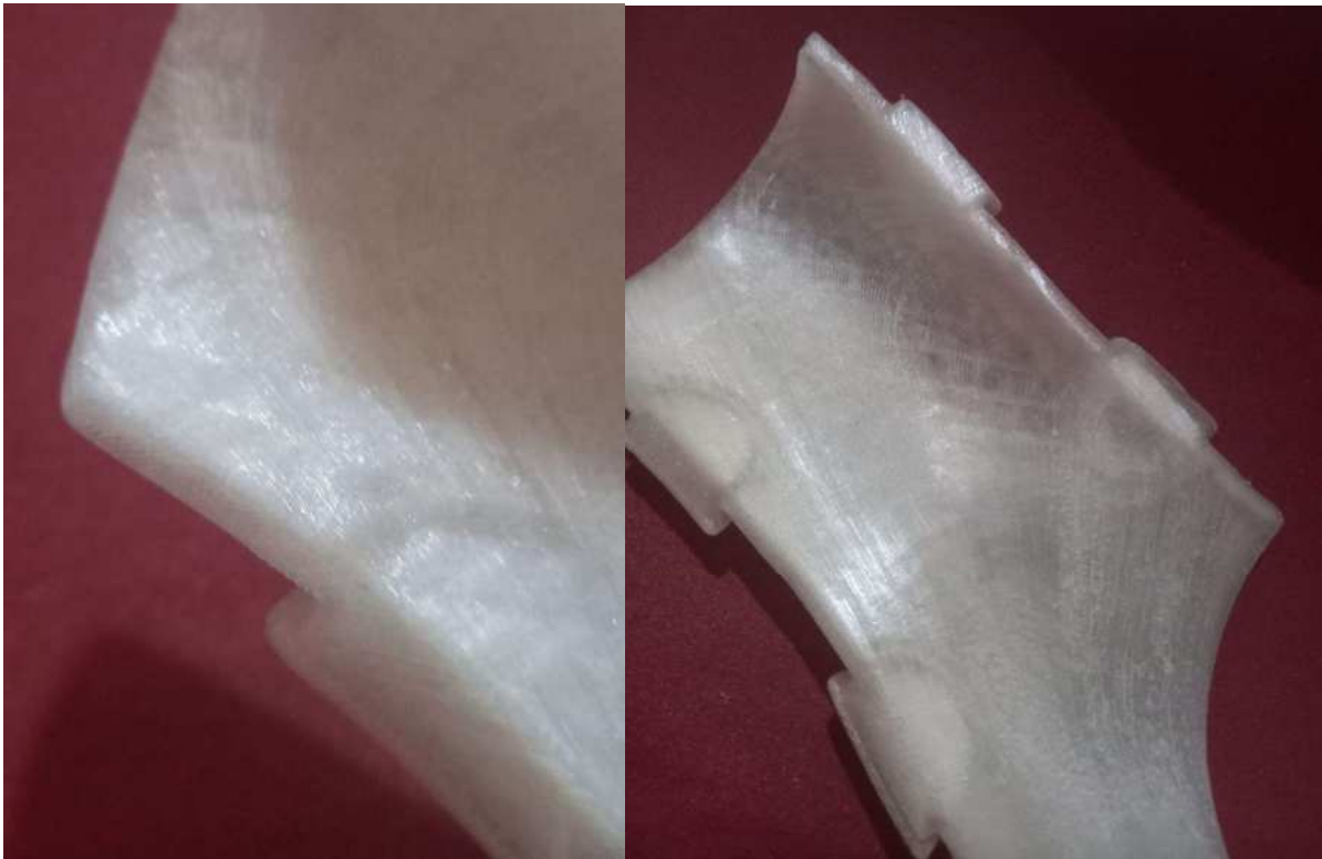
Figuras 93 e 94: Quinas e interior da órtese após acabamento na lixa. Fonte: Autoria própria
