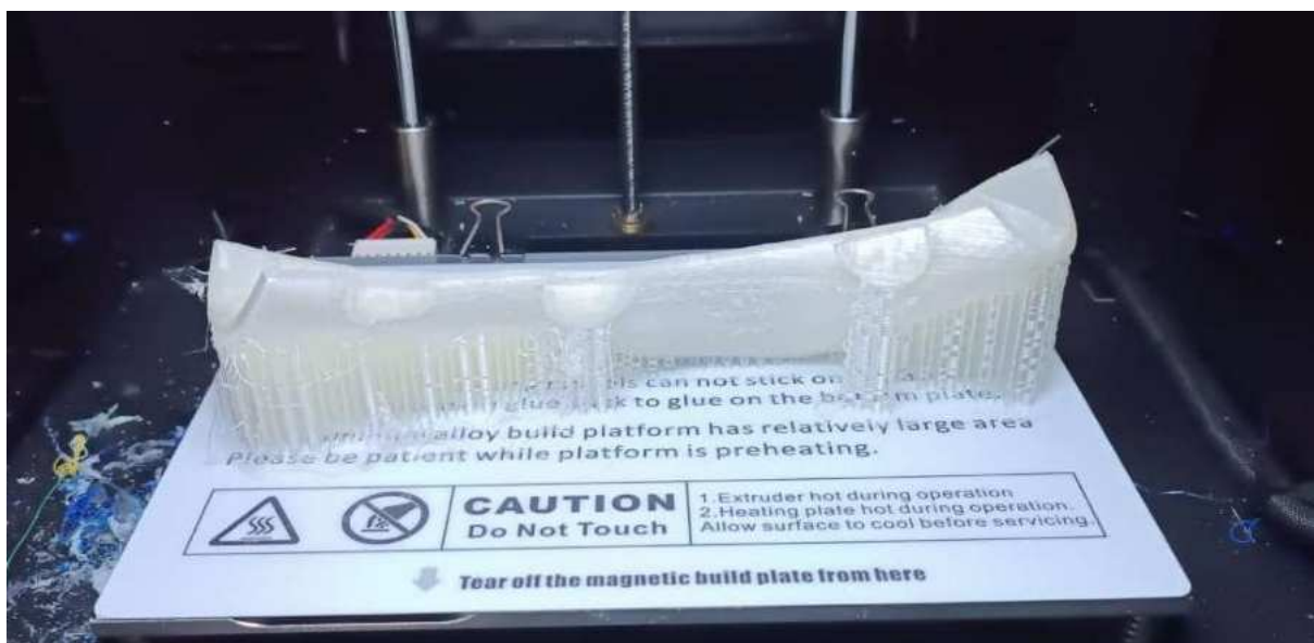
Figura 83: Órtese impressa ainda na mesa. Fonte: Autoria própria
