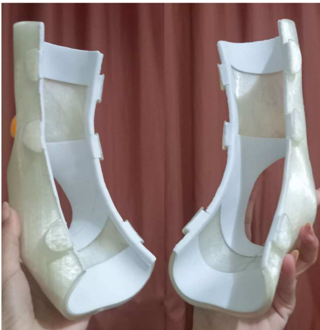
Figuras 127 e 128: Preenchimento interno do modelo sem boleamento final das quinas. Fonte: Autoria própria
