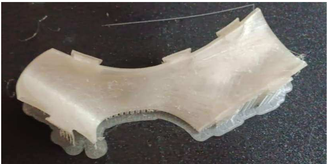
Figura 86: Vistas variadas da órtese impressa com suportes. Fonte: Autorial própria
