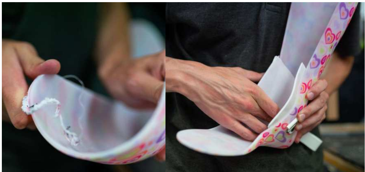
Figuras 17 e 18: Etapa de acabamentos na produção da órtese termoplástica de alta temperatura. Fonte: https://unsplash.com/pt-br/@thisengineering
