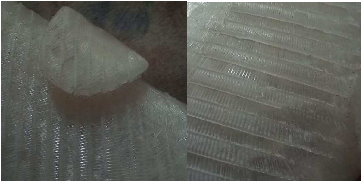
Figuras 87 e 88: Superfície texturizada após retirada dos suportes. Fonte: Autoria própria
