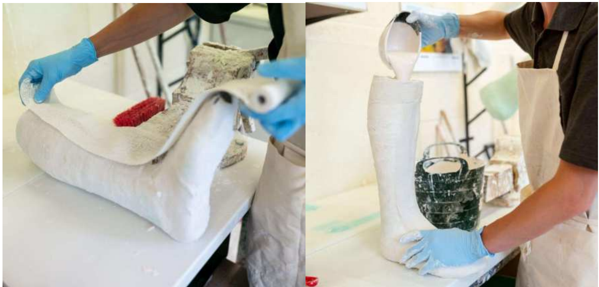
Figuras 13 e 14: Etapa de molde na produção da órtese termoplástica de alta temperatura.
