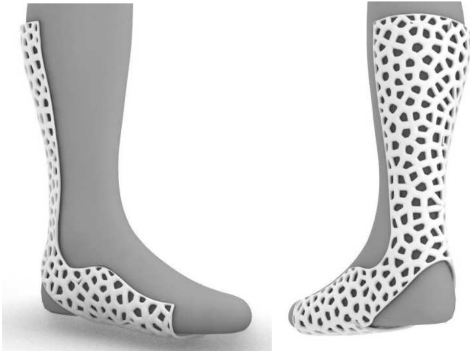
Figuras 60 e 61: Modelagens da superfície da órtese com corte frontal e traseiro. Fonte: Autoria própria
