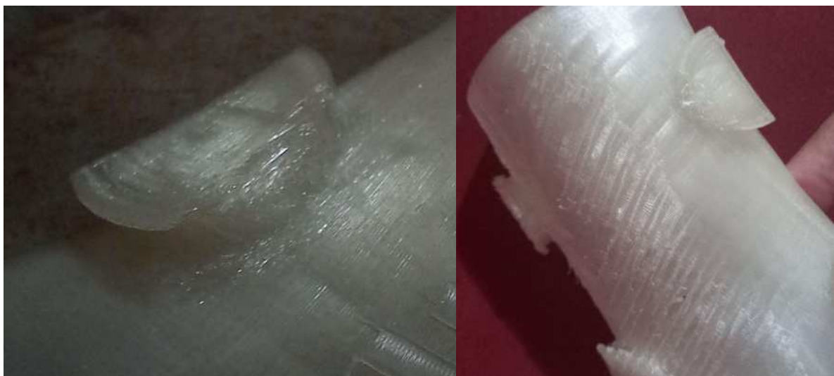
Figura 89 e 90: Erros de impressão notados e superfície texturizada. Fonte: Autoria própria
