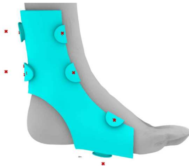
Figura 70: Posicionamento dos encaixes feito no algoritmo. Fonte: Autoria própria
