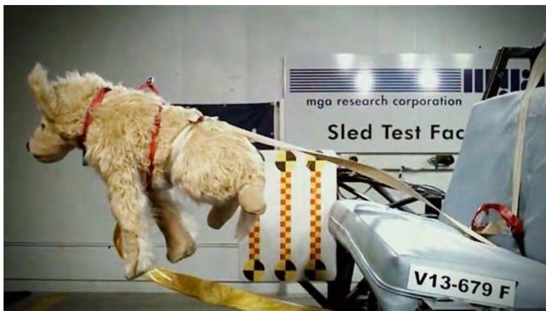
Figura 2: Figura 2:Crash Test com dummy canino realizado pela CPS. Fonte: Cesarsway 2022.
