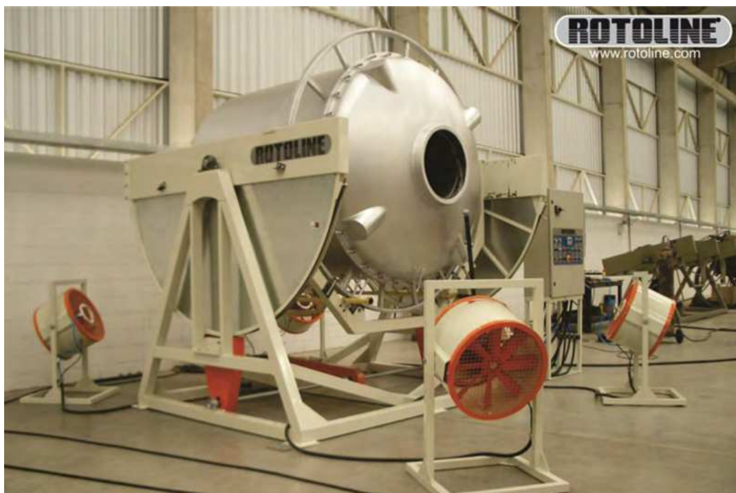
Figura 66: Open Flame - Máquina para Rotomoldagem | Fonte: Rotoline 2023
