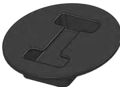
Figura 77: Modelagem Tridimensional - Passador de cinto de segurança | Fonte: Elaboração própria, 2023.
