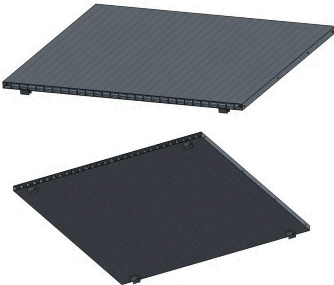
Figura 243 - Vistas do modelo 3D do tampo feito com perfis . Fonte: Elaboração própria.
