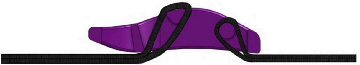
Figura 259 - Vista lateral da peça reguladora de correia e sua interação com a correia. Fonte: Elaboração própria.
