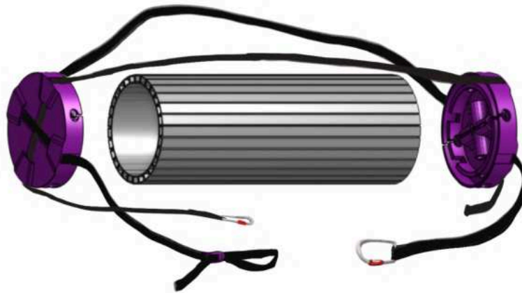
Figura 270 - Modelos 3D e ilustrações simulando interação do cilindro com as correias. Fonte: Elaboração própria.
