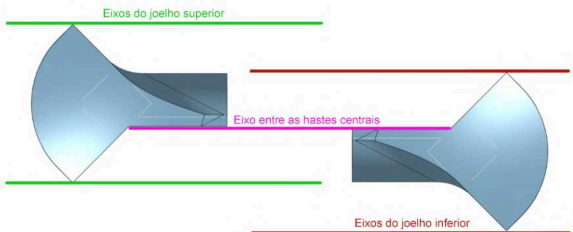
Figura 179 - Modelo 3D dos joelhos, versão 1, focando no desalinhamento de certos eixos, detalhe. Fonte: Elaboração própria.
