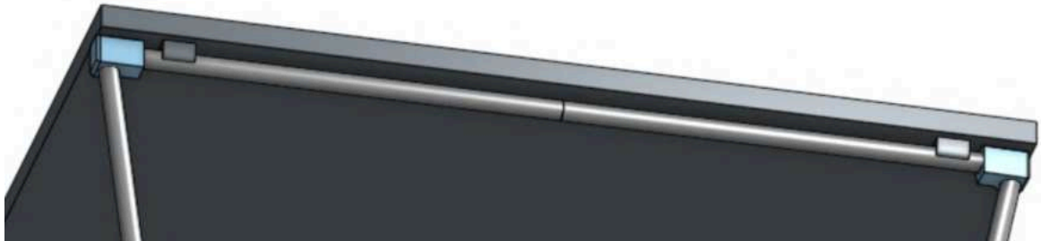
Figura 238 - Vista detalhando encaixe das hastes vigas com o tampo. Fonte: Elaboração própria.
