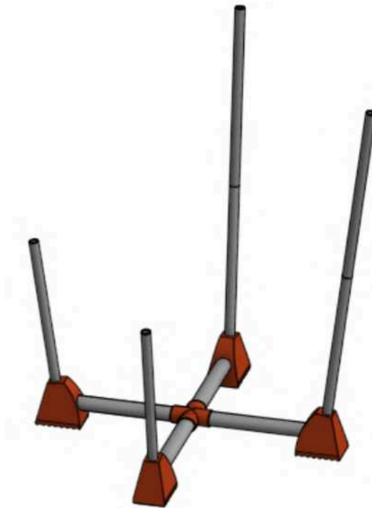
Figura 84 - Modelo 3D da base da cadeira completa, com parte central, pés e pernas. Fonte: Elaboração própria.
