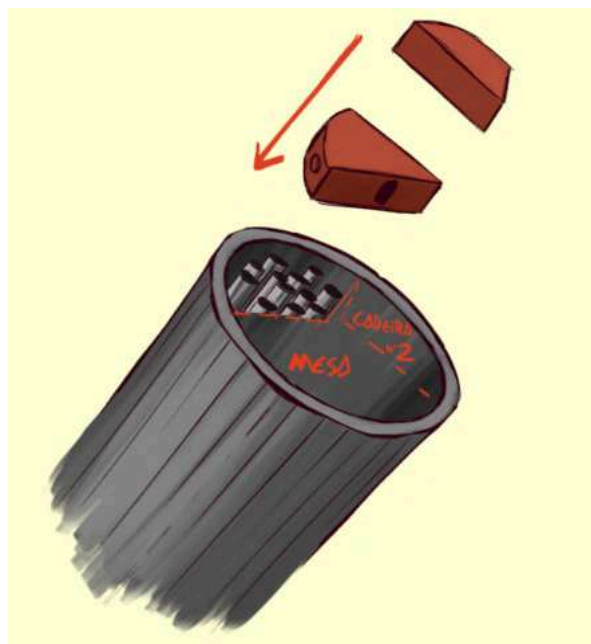
Figura 76 - Ilustração das hastes que compõem as cadeiras e seus pés sendo introduzidos no cilindro que vai reter os itens do produto. Fonte: Elaboração própria.
