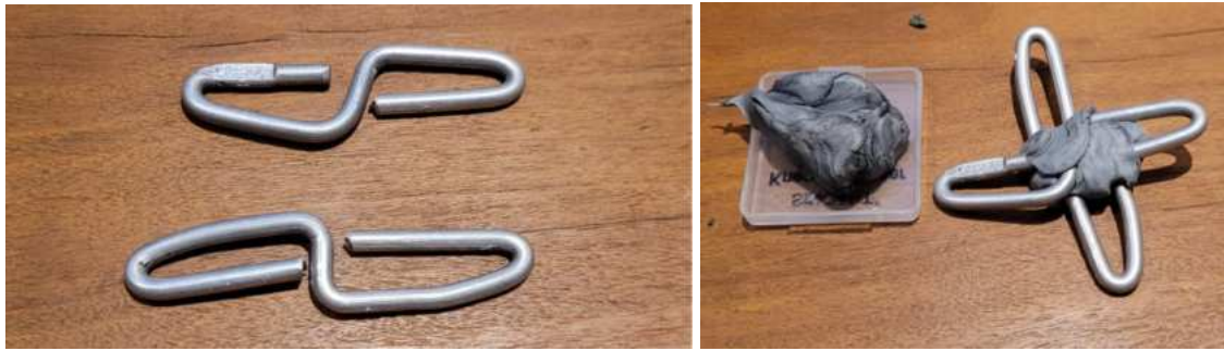
Figura 44 - Teste para configuração de peça de união, feita com hastes de alumínio e borracha limpa-tipo. Fonte: Elaboração própria.
