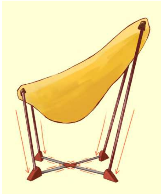
Figura 75 - Ilustração da cadeira atual com a base, setas representam os vetores de força e dirigindo ao solo. Fonte: Elaboração própria.
