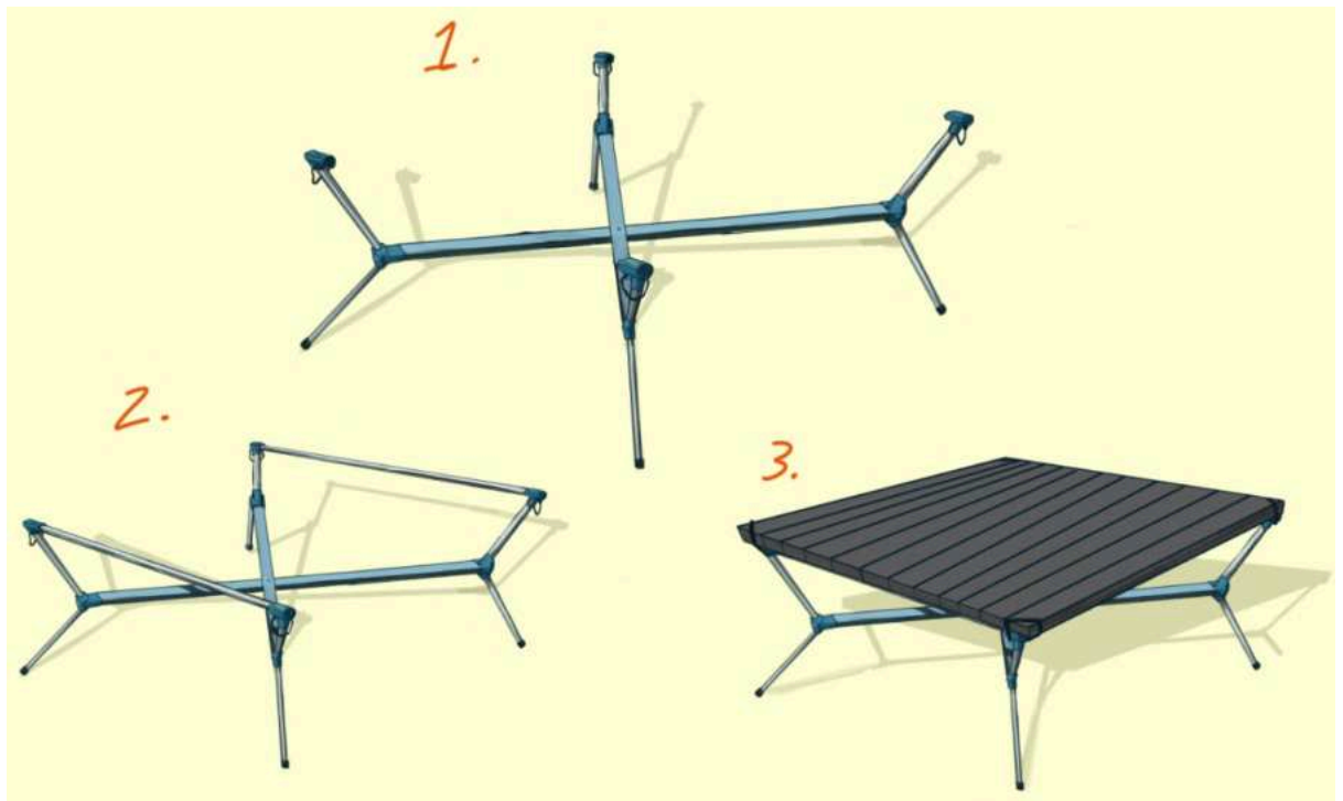
Figura 195 - Processo de montagem da mesa, versão 2. Fonte: Elaboração própria.
