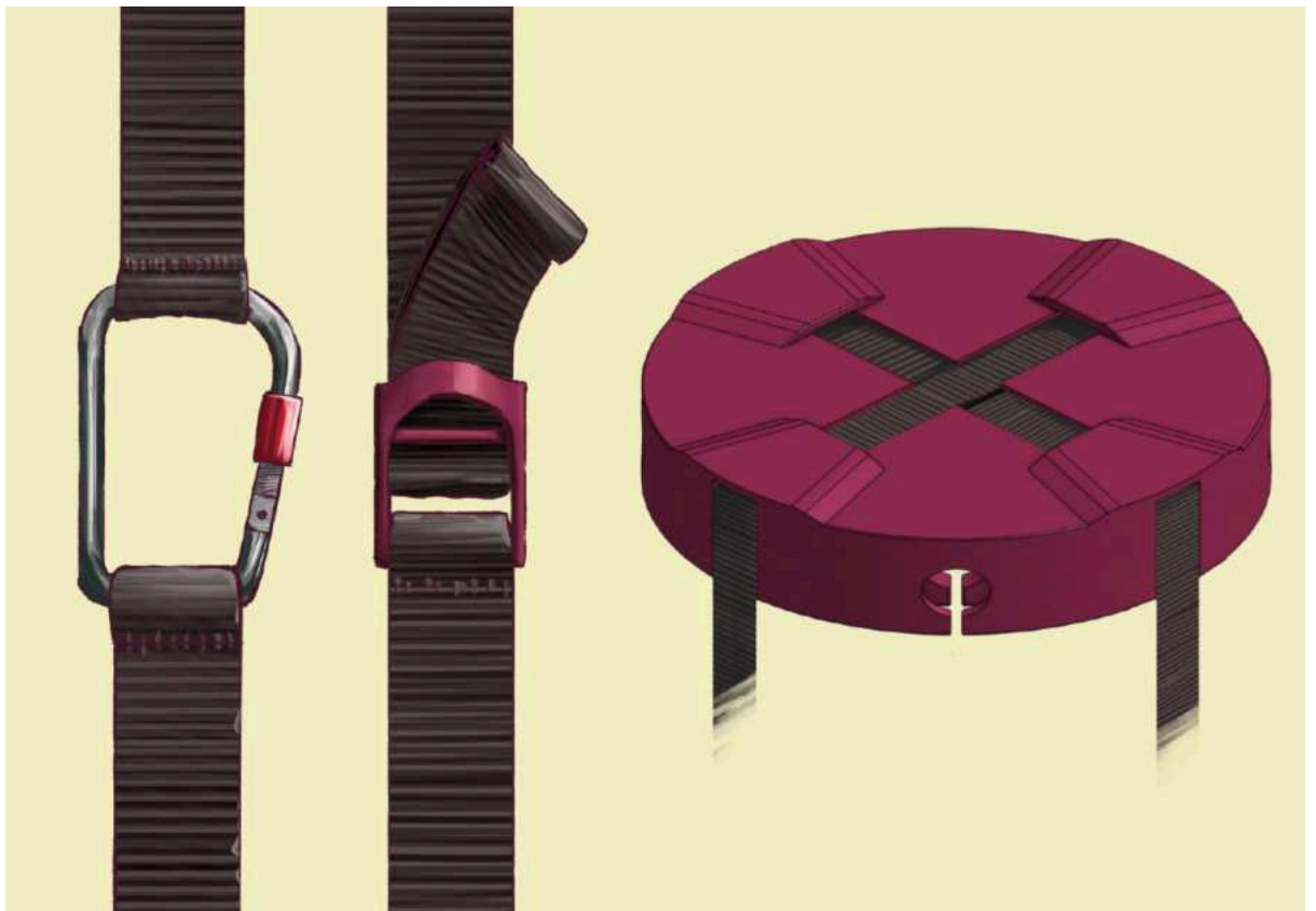
Figura 269 - Ilustrações do mosquetão, peça reguladora, e a interação das correias com a tampa. Fonte: Elaboração própria.
