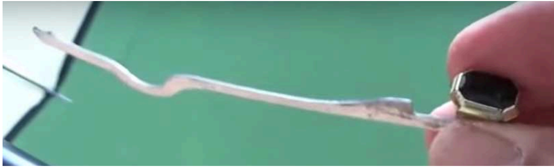
Figura 79 - Foto da peça responsável pelo travamento de um mecanismo de um guarda-chuva. Fonte: https://www.youtube.com/watch?v=xAsxi0EbQBk&t=636s
