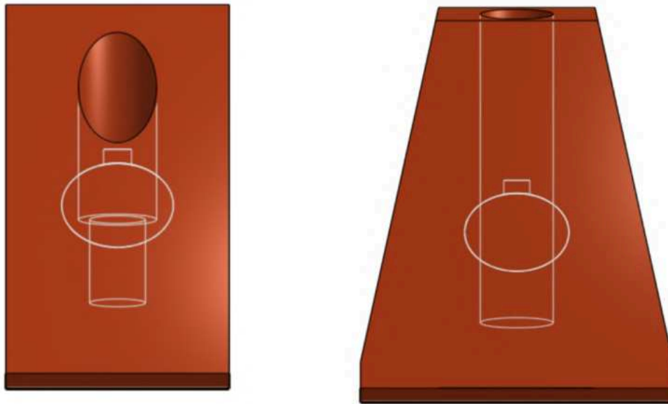
Figura 88 - Modelo 3D da nova versão do pé, agora com forma trapezoidal e base maior do que em versões anteriores. Fonte: Elaboração própria.
