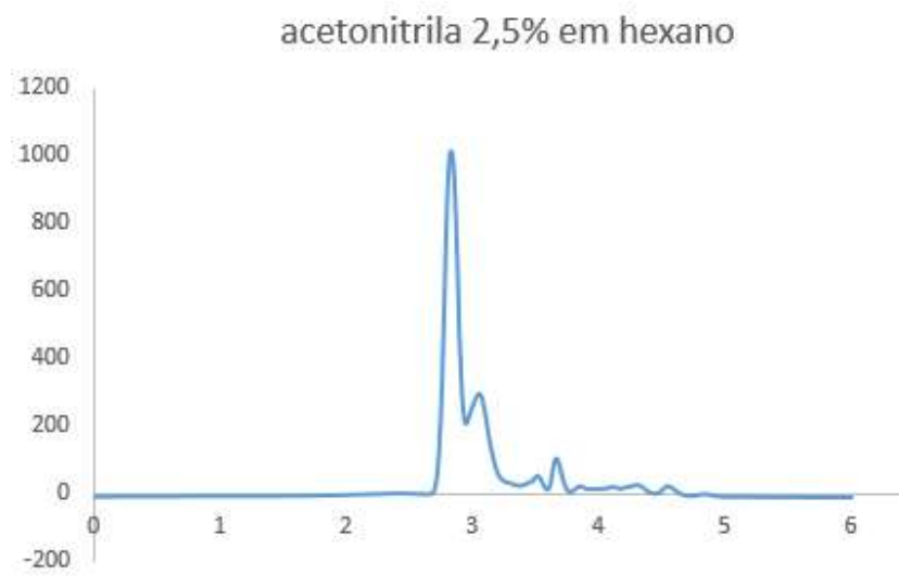
Figura 1H. Cromatograma utilizando fase móvel; 2,50% volumétrico de acetonitrila em n -hexano na análise de amostra biodiesel:óleo vegetal:óleo diesel.
