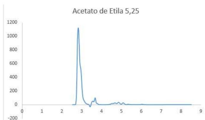
Figura 1B. Cromatograma utilizando fase móvel; 5,25% volumétrico de acetato de etila em n -hexano na análise de amostra biodiesel: óleo vegetal: óleo diesel.
