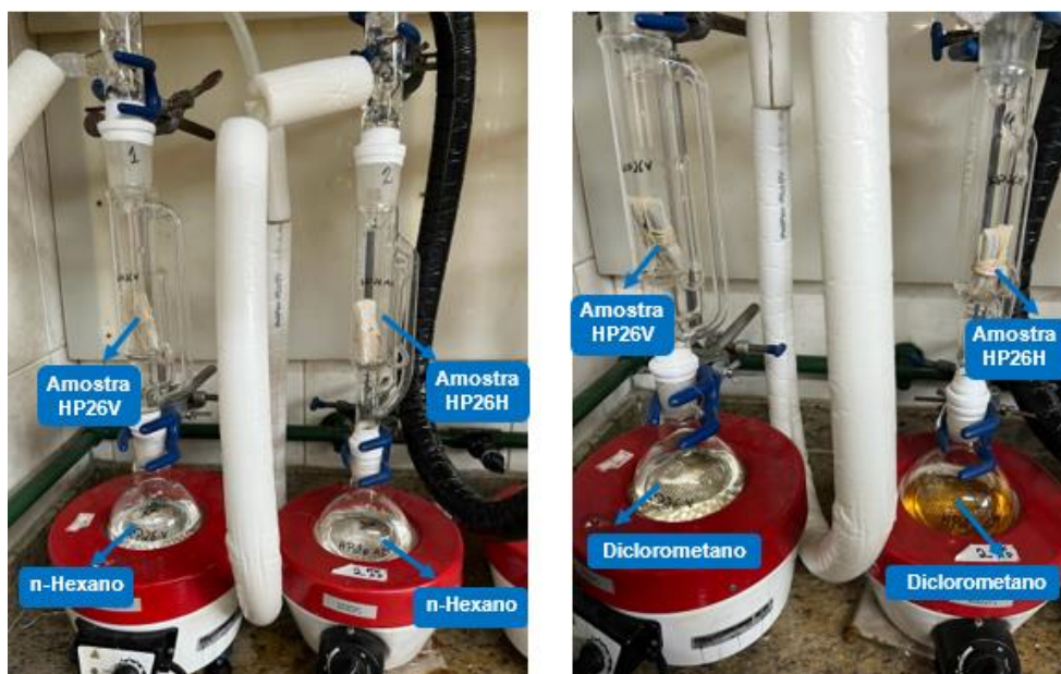
Figura 16 – Extração sob refluxo com extrator Soxhlet dos compostos orgânicos contidos nas amostras HP26V e HP26H.
