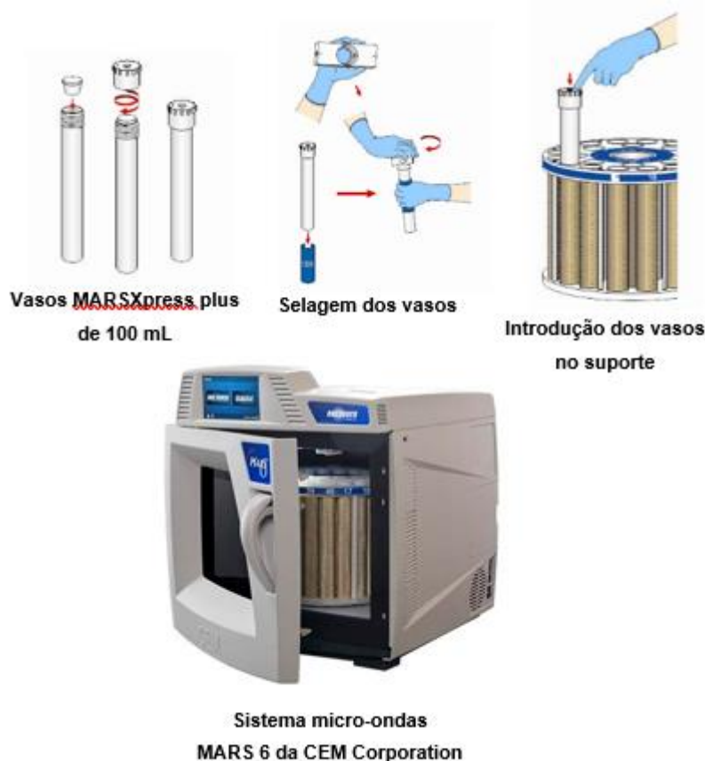
Figura 14 – Esquema geral do micro-ondas MARS 6 da CEM Corporation utilizado nesse trabalho.
