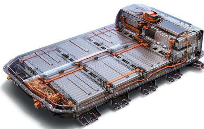
Figura 10 – Módulo de Bateria de íons de lítio
