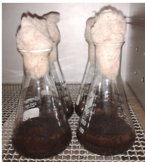
Figura 4 Frascos contendo a borra de café inoculados com Trichoderma harzianum 4040 para determinação da cinética de produção de 6-PP.
