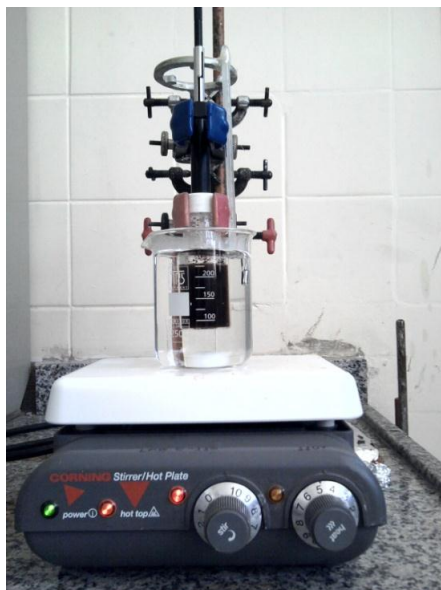
Figura 5 Aparato para microextração em fase sólida por headspace de 6-PP.
