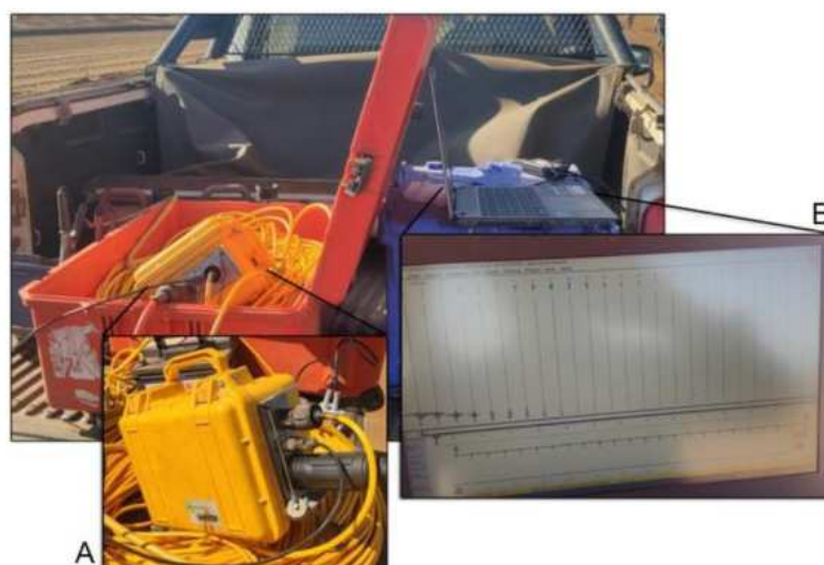
Figura 16: Fotos dos equipamentos da base de aquisição de dados. A) Um sismógrafo Geode de 24 canais para digitalização das formas de onda observadas por geofones; B) Um computador com software de aquisição de dados.
