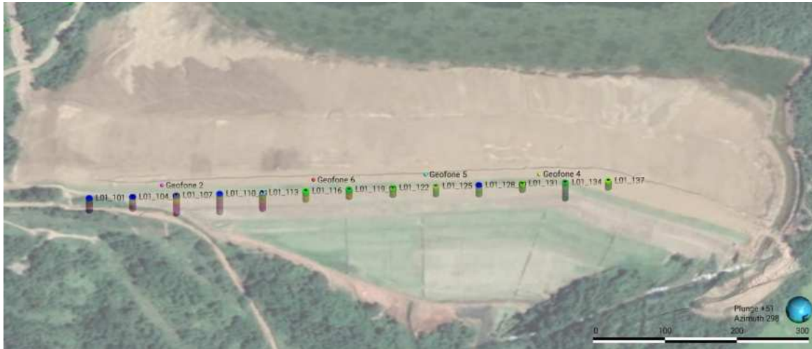
Figura 18: Localização dos geofones utilizados para interferometria sísmica do ruído ambiente e localização dos pontos de aquisição do MASW.
