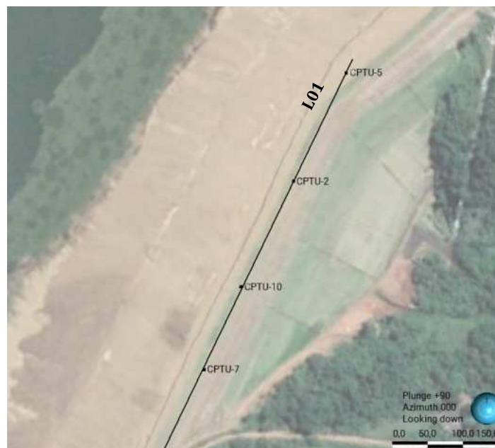
Figura 22: Localização dos ensaios de piezocone distribuídos ao longo da L01 de MASW em T0.
