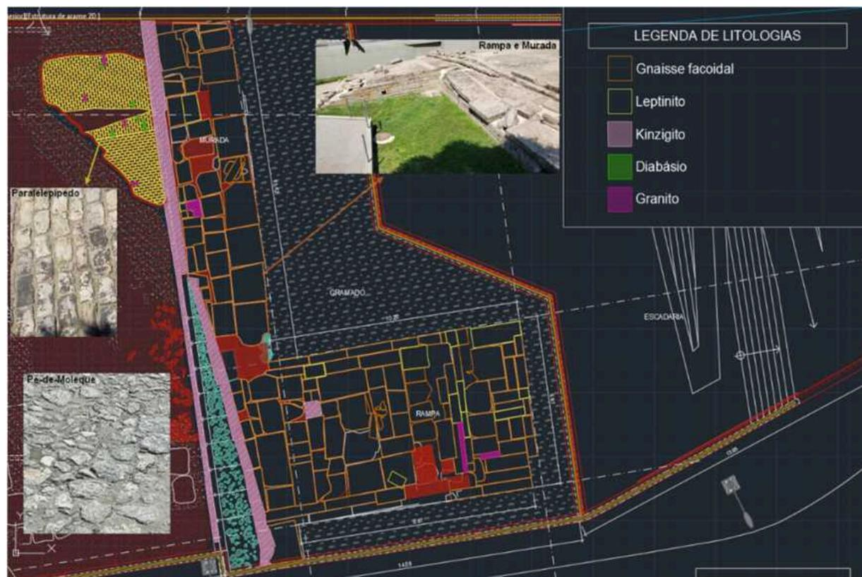
Figura 23: Modelo bidimensional (2D) do Cais do Valongo elaborado em AutoCAD.
