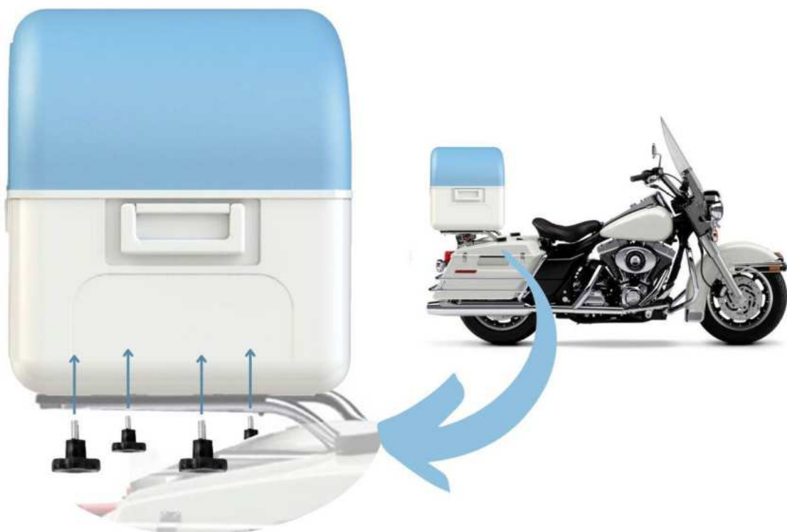
Imagem: 70, montagem do suporte com parafusos borboleta, autoria própria, 2023.
