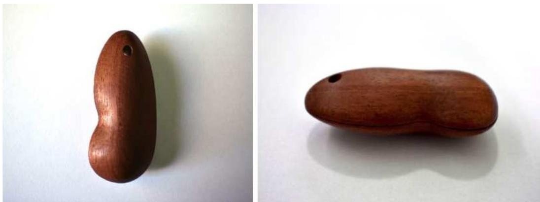
*Figuras 219 e 220: Parte externa do Segurador após acabamento com lima e lixas (Fonte: acervo próprio)*
