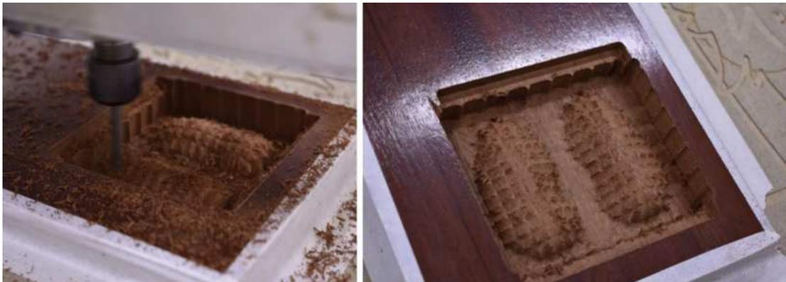
*Figuras 207 e 208: Rebaixamentos na vertical e na horizontal (Fonte: acervo próprio)*
