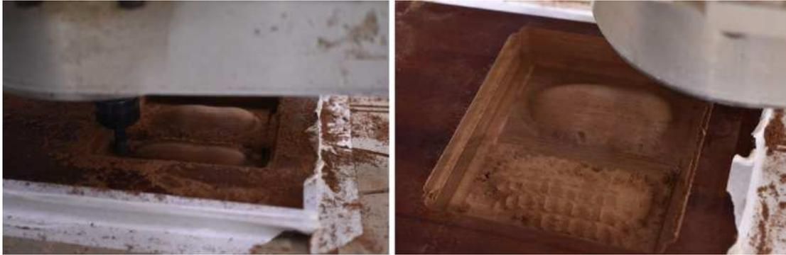
*Figuras 209 e 210: Rebaixamentos com fresa mais arredondada para melhor acabamento (Fonte: acervo próprio)*
