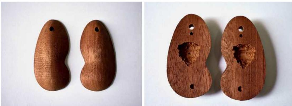
*Figuras 213 e 214: Segurador após a usinagem, sem acabamento (Fonte: acervo próprio)*
