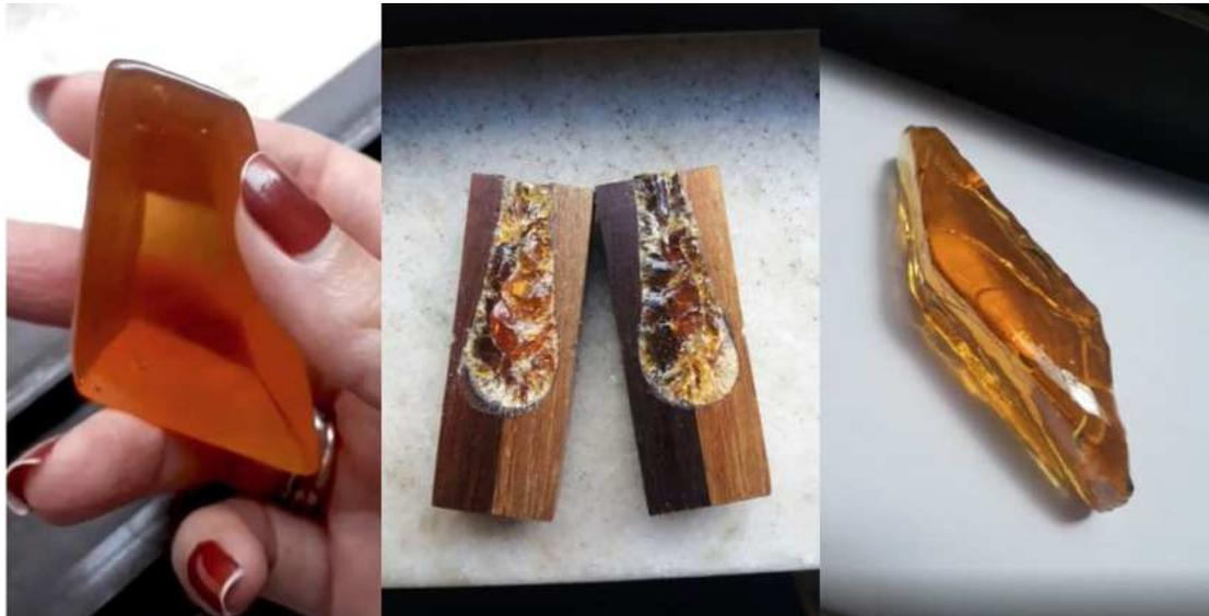
*Figura 124 (direita): Forma do breu colofônia após conformada em molde de silicone (Fonte: acervo próprio)*
