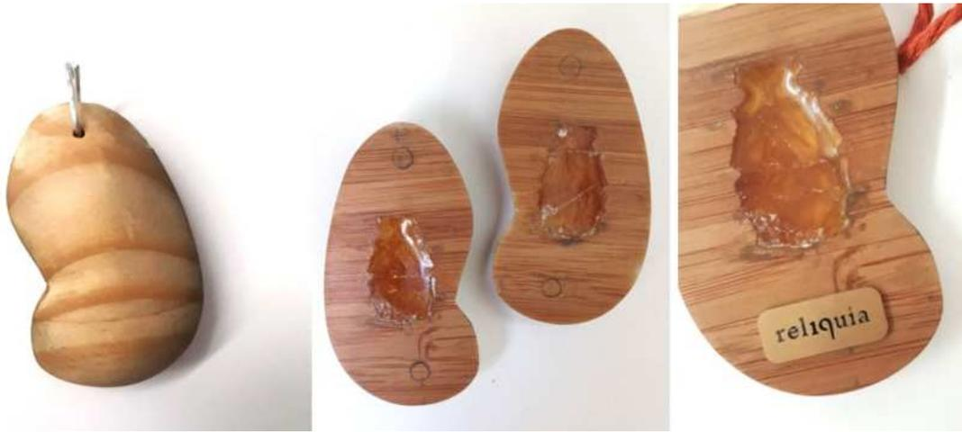
*Figuras 169, 170 e 171: Problemas no primeiro teste do segurador: madeira suja e breu melado e trincado em contato com o óleo essencial (Fonte: acervo próprio)*
