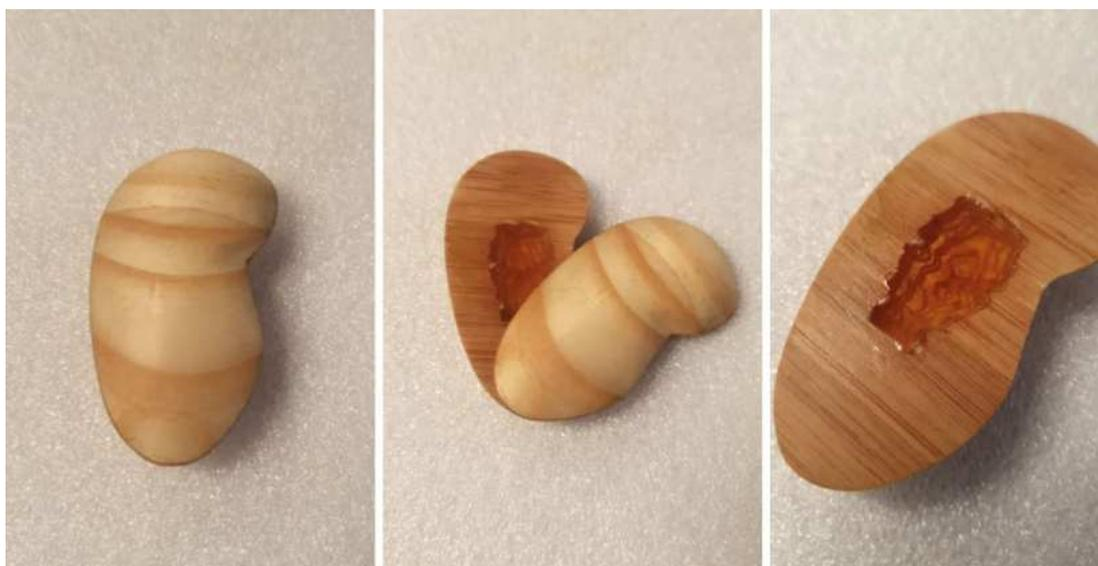
*Figuras 166, 167 e 168: Primeiro teste do segurador. Feito em pinus e com a representação do vazio em forma de vaso (Fonte: acervo próprio)*
