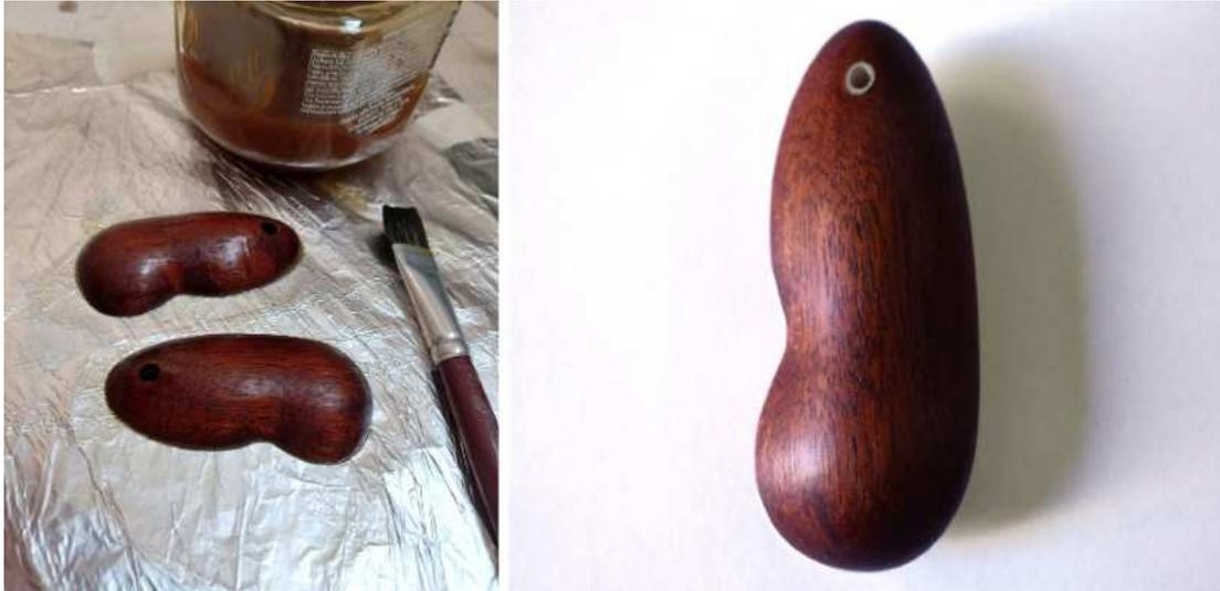
*Figura 223 (esquerda): Acabamento na madeira com óleo de linhaça (Fonte: acervo próprio)*
