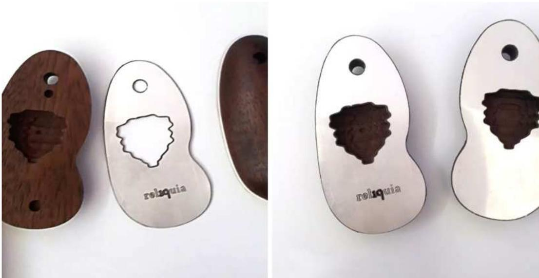
*Figuras 217 e 218: Placa de prata cortada e gravada à laser ao lado da madeira (Fonte: acervo próprio)*
