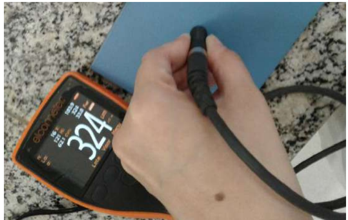
Figura 33 - Medição de espessura do revestimento polimérico após aspersão. Fonte: Arquivo Pessoal
