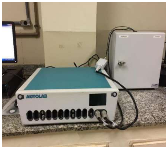
Figura 26 - Potenciostato-Galvanostato AUTOLAB PG 302N, utilizado na realização dos experimentos de espectroscopia de impedância eletroquímica. Fonte: Arquivo pessoal
