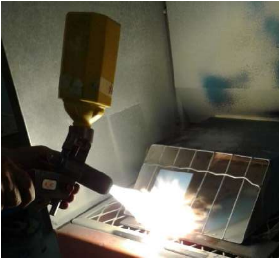
Figura 20 - Processo de Aspersão Térmica. Fonte: Arquivo pessoal
