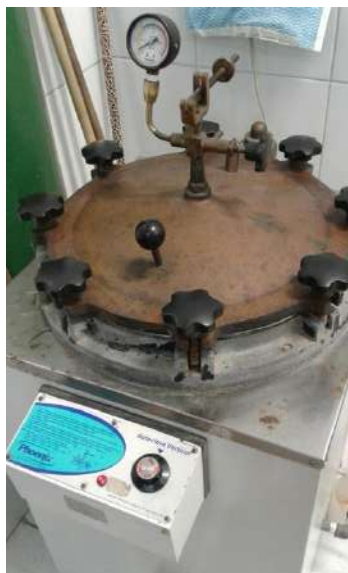
Figura 12 - Processo de Autoclavagem da Água do Mar. Fonte: Arquivo Pessoal
