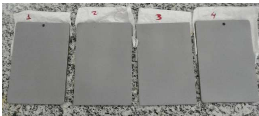
Figura 18 - Corpos de prova preparados para revestimento. Fonte: Arquivo pessoal
