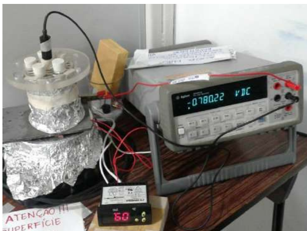
Figura 24 - Ensaio de OCP para aço carbono sem revestimento a 60°C. Fonte: Arquivo pessoal
