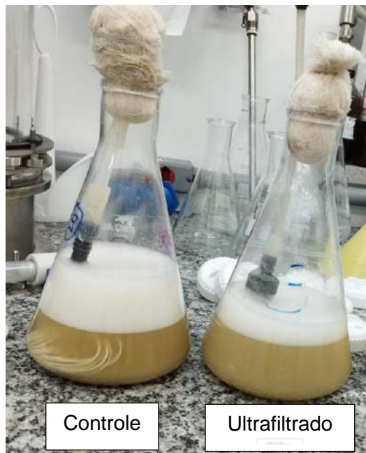
Figura 12. Formação de espuma nos frascos agitados devido a presença do módulo de ultrafiltração
