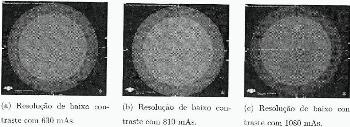
Figura 4.10: Resolução de baixo contraste no Catphan ® para as três correntes selecionadas: (a) 630 mAs, (b) 810 mAs e (c) 1080 mAs.
