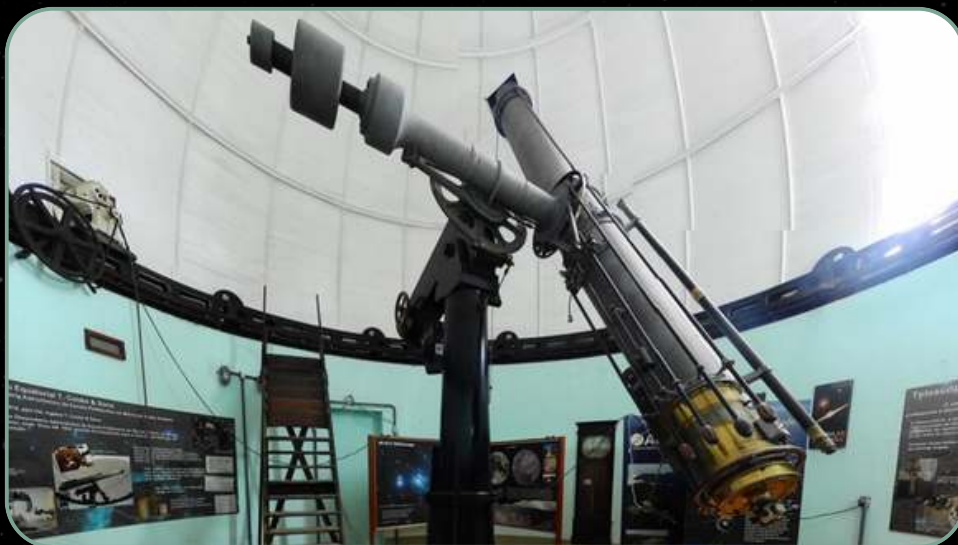
O Refrator Equatorial T. Cooke & Sons Ltd - London & York | 300mm, f18. Créditos: Daniel Mello e Observatório do Valongo da UFRJ.
