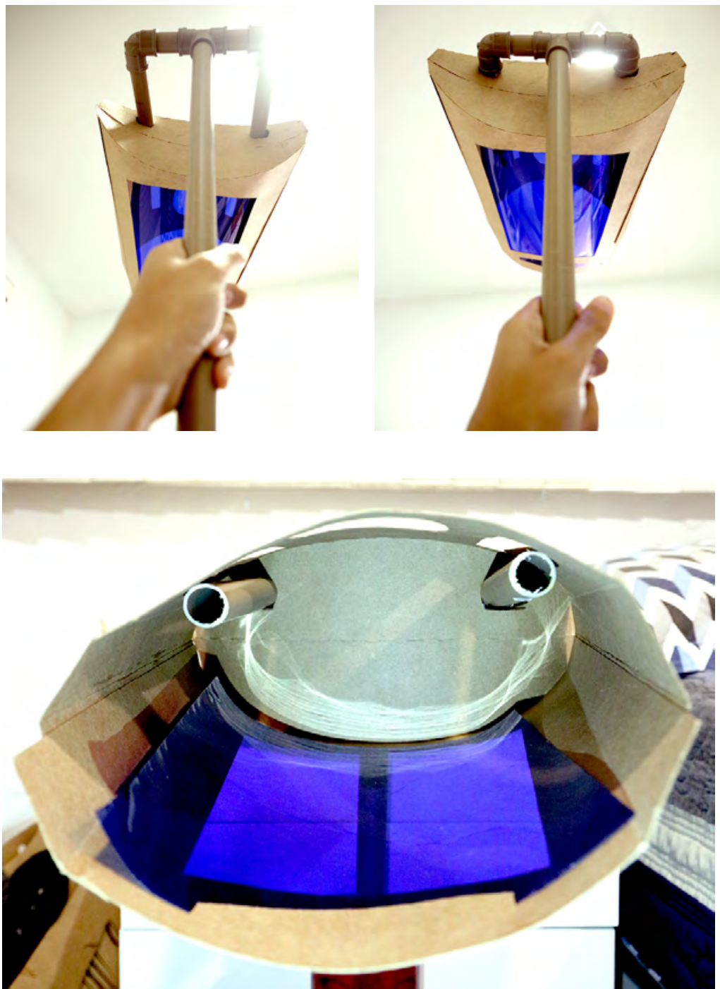
Figura 96- garfo de instalação feito com tubos pvc Fonte: Autoria Própria
