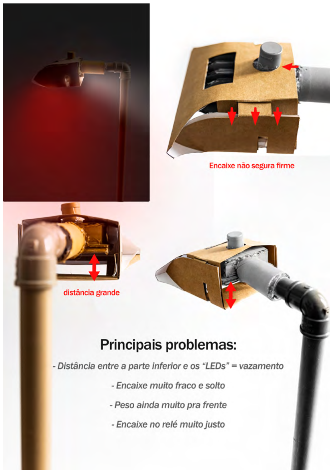
Figura 82- prancha de identificação de problemas nos testes realizados Fonte: Autoria Própria
