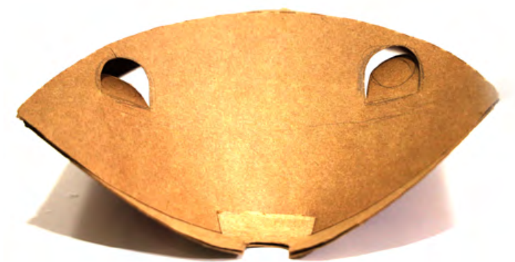
Figura 102- solução de estruturação por trava recortada em uma das face Fonte: Autoria Própria
