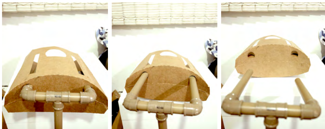
Figura 95- garfo de instalação feito com tubos pvc Fonte: Autoria Própria
