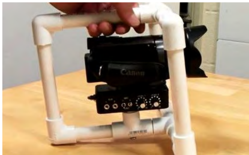
Figura 58- Suporte de câmera para filmagem feito em PVC Fonte: Pinterest
