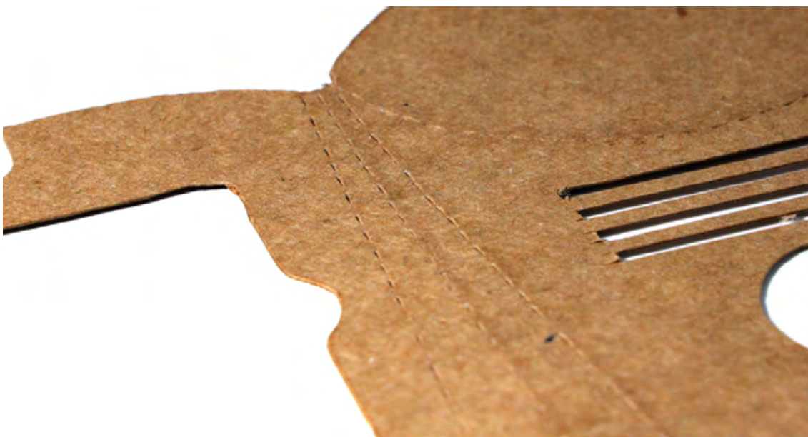
Figura 110- Detalhe de pontilhamento para auxiliar na dobra Fonte: Autoria Própria
