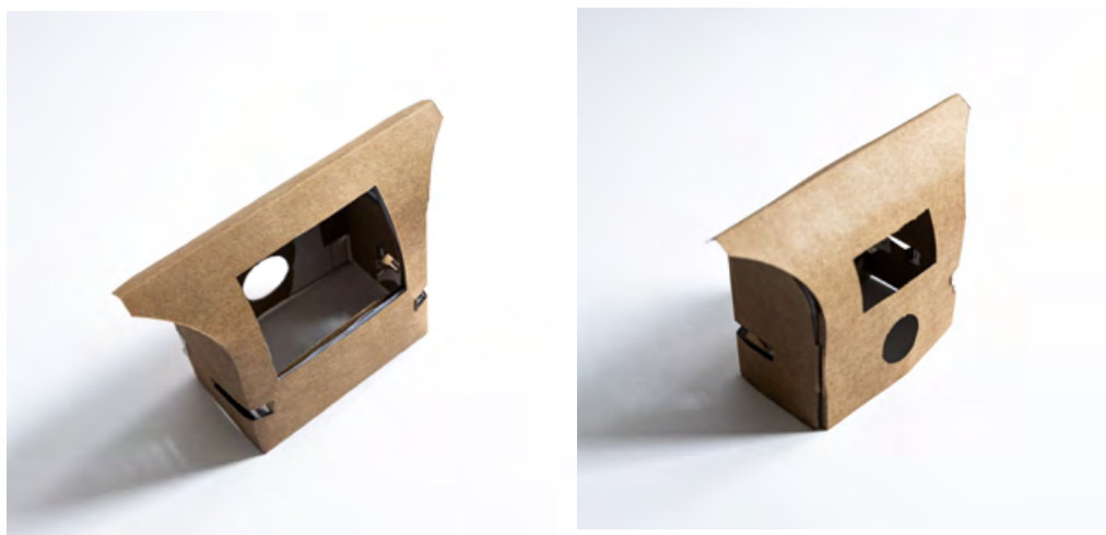
Figura 79- Forma obtida a partir da planificação construída em escala 1:4 Fonte: Autoria Própria
