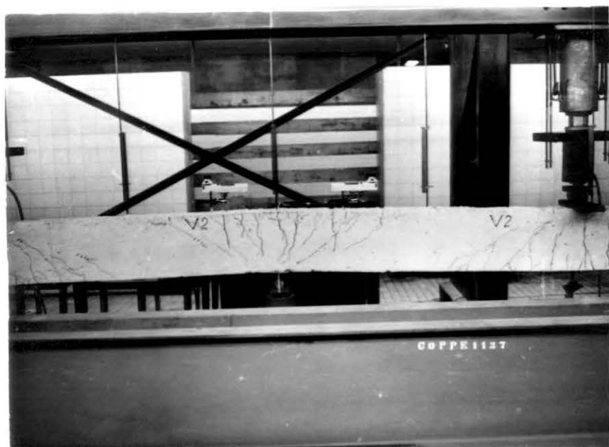
Fig. 4.24 - Fotografia 7: Vista da região do apoio central da viga V2, (após o ensaio)
