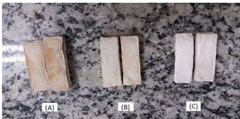
Figura 13. Corpos de prova após a queima: (A) R600, (B) R800, (C) R1000
