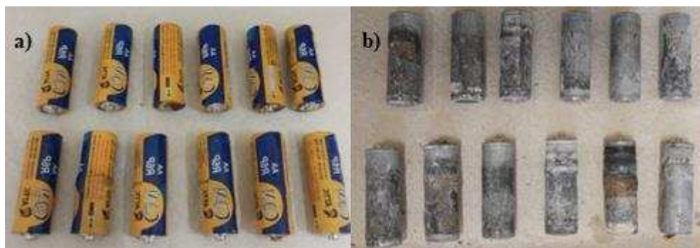
Figura 3: Pilhas utilizadas no experimento, em 3.a) com o lacre plástico e, em 3.b) já sem ele, possibilitando a verificação das condições do invólucro de metal (Autoria própria).
