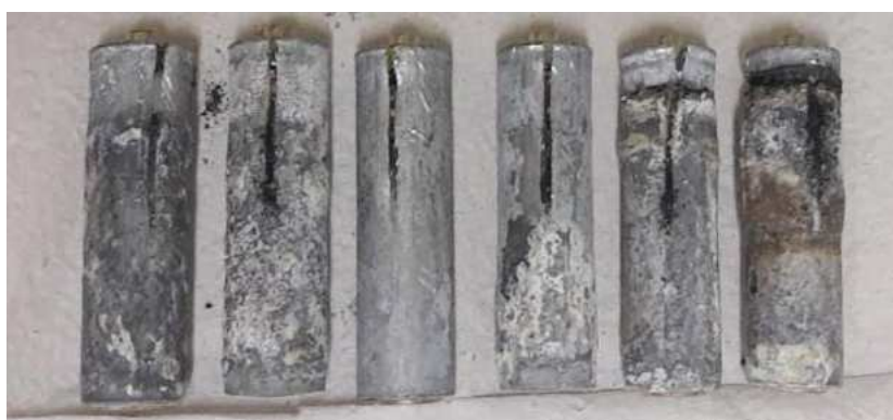
Figura 4: Cortes das pilhas simulando a condição de rompimento (Autoria própria).
