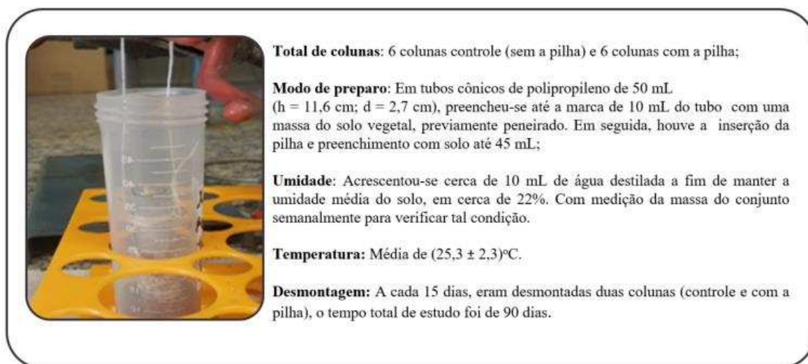
Figura 6: Arranjo das colunas e parâmetros definidos conforme os protocolos adotados (Autoria própria).
