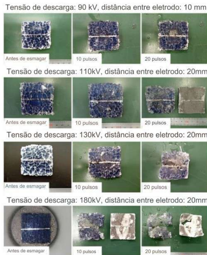
Figura 22: Produtos de método de pulso de alta voltagem em diferentes voltagens
