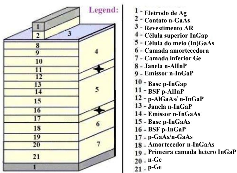
Figura 11: Esquemática de uma célula de multijunção
