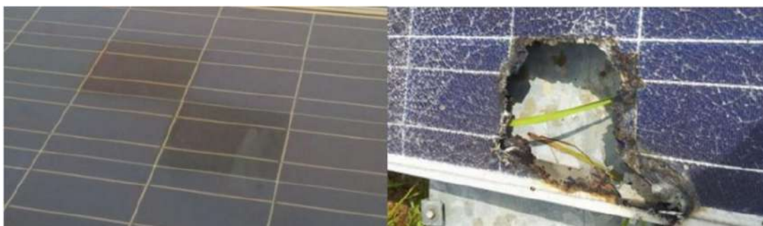
Figura 16: Exemplos de pontos de aquecimento de células fotovoltaicas
