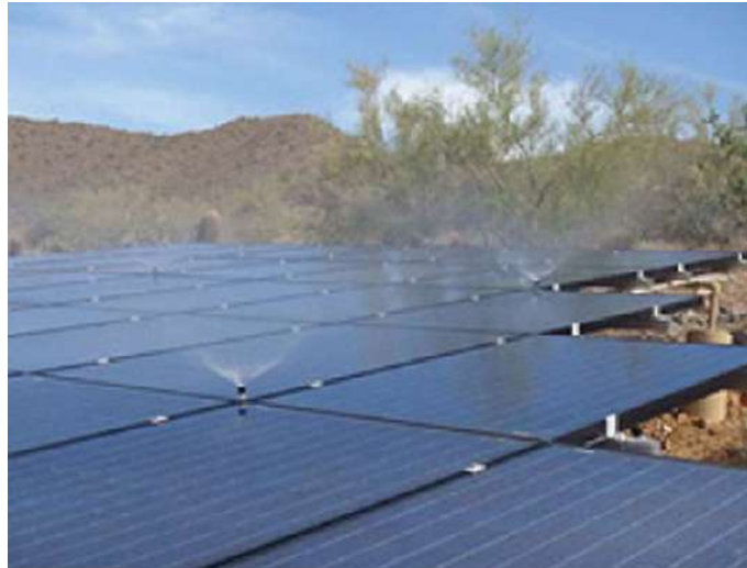
Figura 15: Sistema experimental de refrigeração de painéis fotovoltaicos em Pisa (CAZZANIGA et al., 2017).
