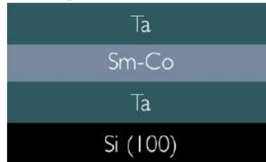
Figura 3.9: Ilustração do depósito do filme de Sm-Co em buffer de Ta.
