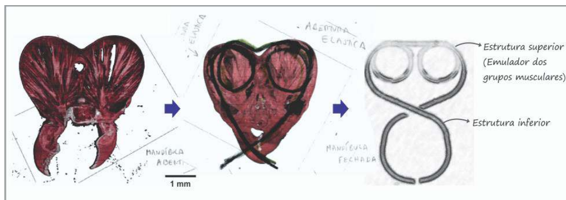
Figura 52 – Projeto grampo de sutura com duas molas com base na musculatura contida na cabeça da espécie, identificado através da microtomografia por transmissão de raios X.
