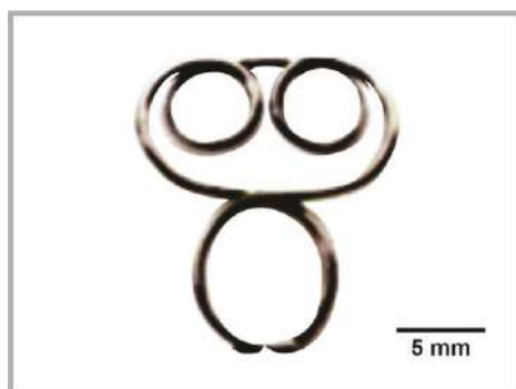
Figura 68 – Protótipo do grampo de sutura de duas molas em aço inoxidável AISI 420, escala 1:1.
