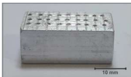
Figura 42 – Molde metálico fabricado para a homogeneização dos recobrimentos nas amostras de fio AISI 420, via técnica solvent casting .
