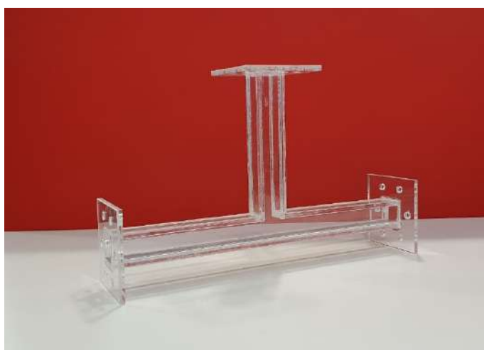
(a) Junta ‘T’ em acrílico com a chapa-alvo totalmente inserida.
