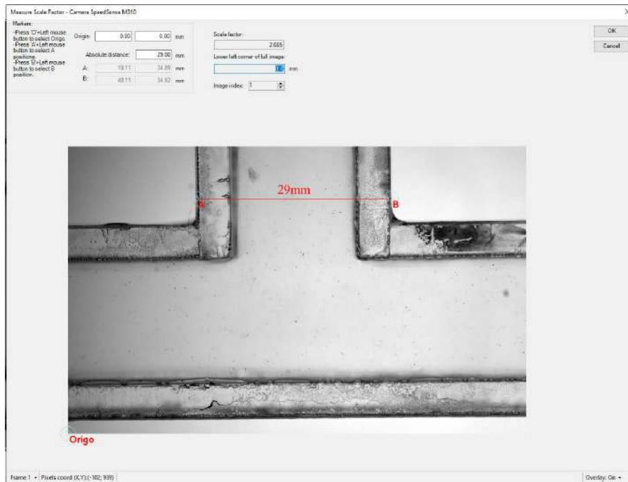
Figura 3.22: Exemplo de imagem de calibração utilizada no sistema PIV.
