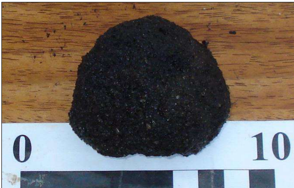
Figura 9 - Amostra de subsuperfície (14,2 m) de arenito rico em matéria orgânica em Maricá - RJ, encontrada durante a pesquisa de Silva (2011). Fonte: Silva (2011).
