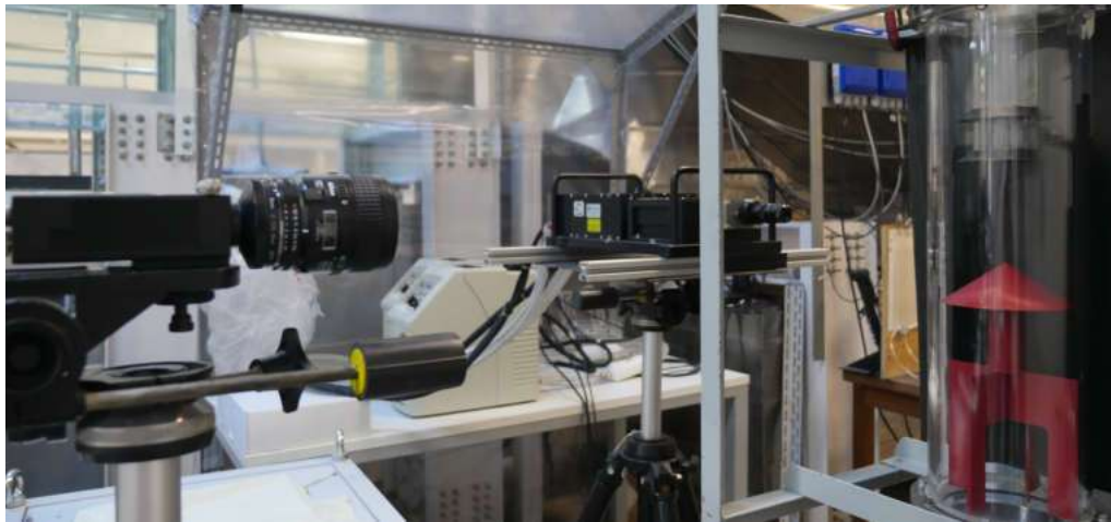
Figura 4.1: Montagem do sistema PIV-2D no protótipo
