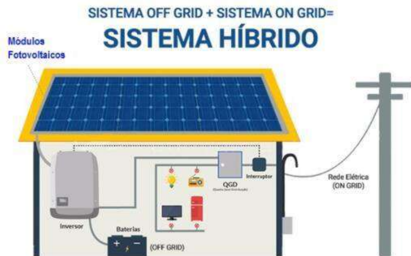
Figura 7: Esquema de sistemas solares fotovoltaicos híbridos. Fonte: OCA SOLAR ENERGIA, 2022.
