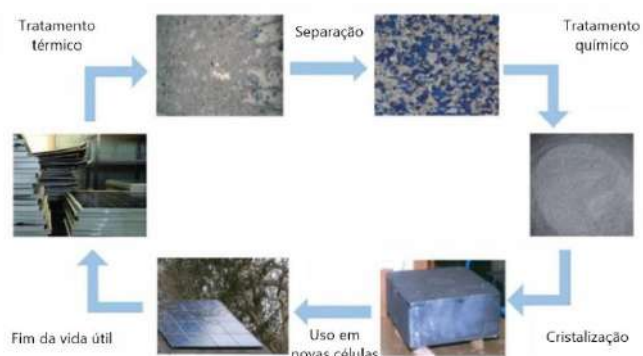
Figura 13: Esquema do processo para reciclagem de módulos fotovoltaicos de silício cristalino. Fonte: Adaptado de FTHENAKIS, 2018.
