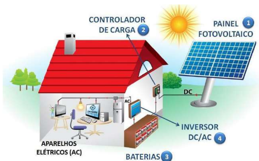
Figura 4: Esquema de sistemas solares fotovoltaicos off-grid sem armazenamento. Fonte: NEOSOLAR, 2022.
