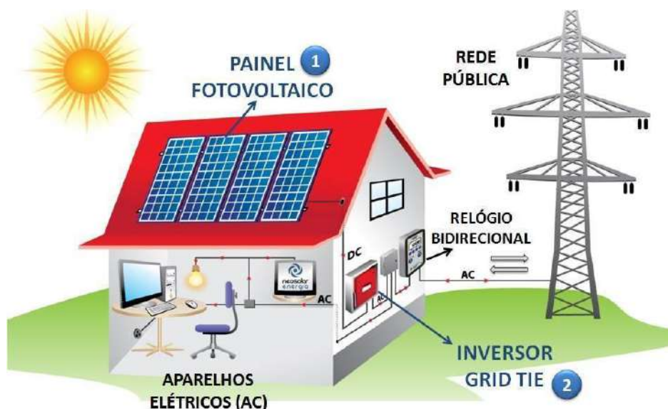
Figura 6: Esquema de sistemas solares fotovoltaicos on-grid. Fonte: NEOSOLAR, 2022.
