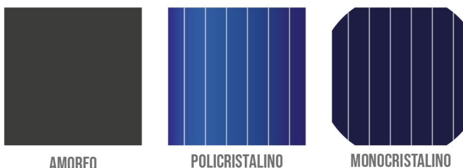
Figura 2: Comparação visual de células fotovoltaicas compostas por silício amorfo, policristalino e monocristalino. Fonte: AUTOSOLAR, 2023.
