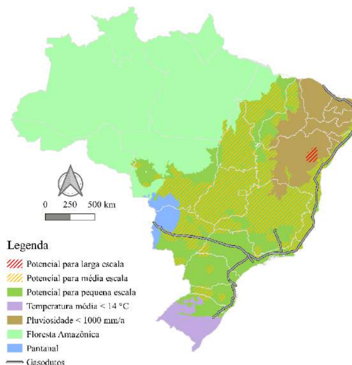
Figura 4.13. Análise geoespacial no QGIS para a implementação de biorrefinarias de macaúba no Brasil, estratificado em áreas com potencial para larga, média e pequena escala, considerando restrições logísticas, agrícolas e ambientais.
