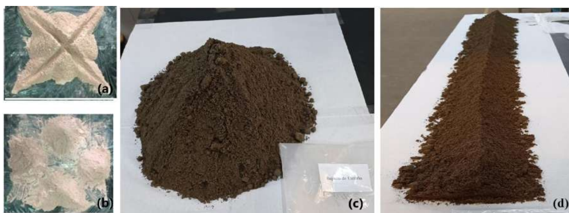
(a), (b) e (c) Representação de Pilha Cônica para quarteamento; (d) Pilha Longitudinal da Escória para homogeneização.
