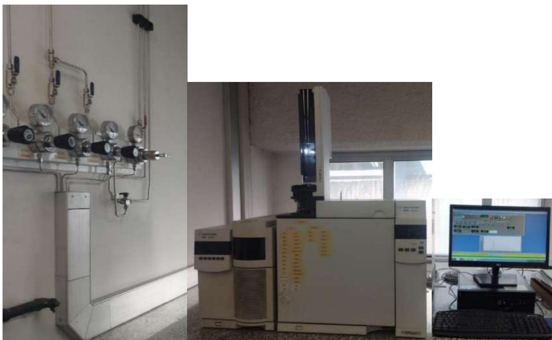
Figura 4.5 – Cromatógrafo a Gás Modelo 7820N da Marca Agilent Technologies
