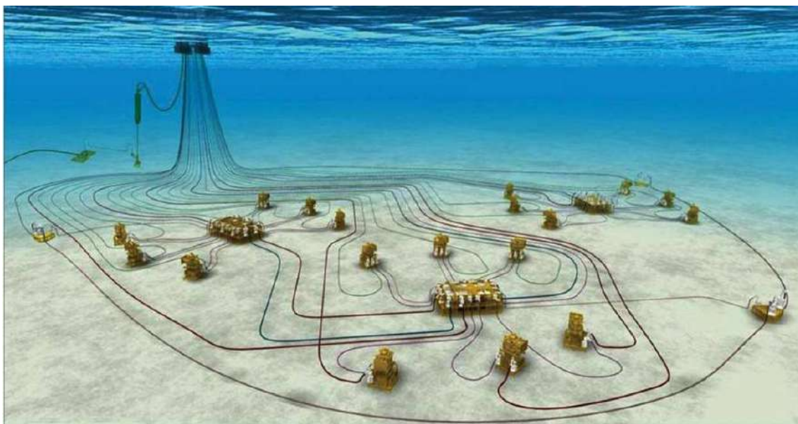
Figura 33 - Arranjo submarino típico para Produção de Óleo e gás (Fonte: www.marinelink.com )
