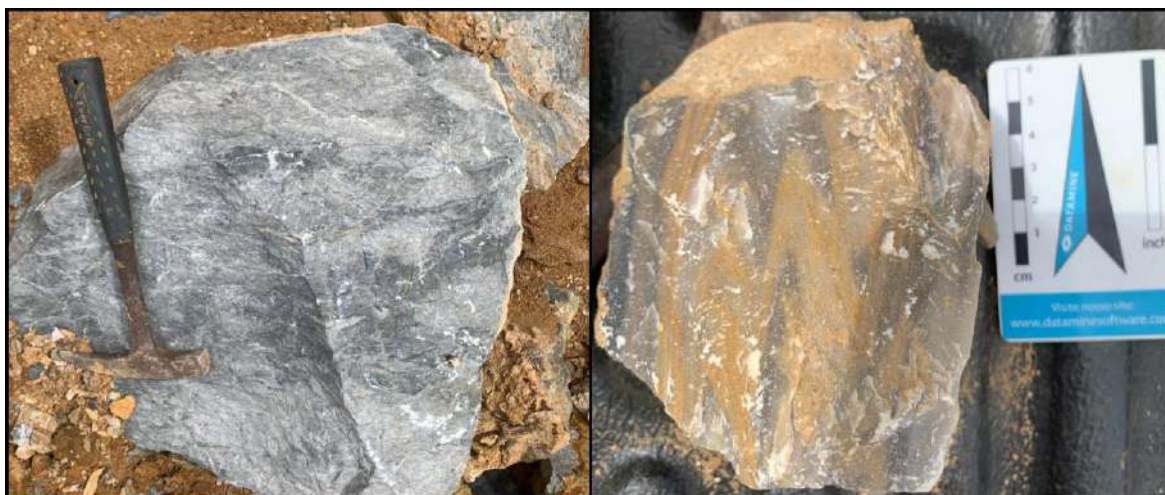
Figura 15 – Dois tipos diferentes de carbonatos, um maciço dolomítico e outro calcítico laminado e deformado.
