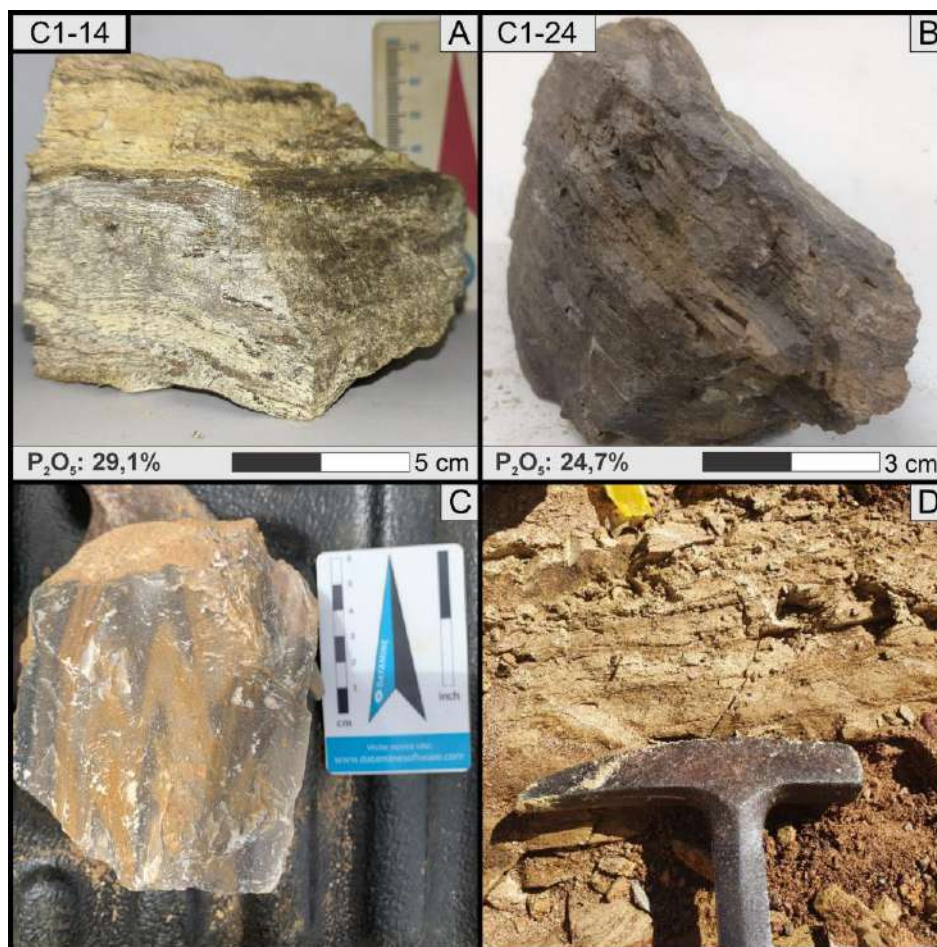
Figura 30 – Amostras da canaleta 1. A: Amostra de metassiltito laminado (C1-14); B: Amostra de brecha monomítica (C1-24); C: Calcário deformado ao fim da C1; D: Filito do início da canaleta.
