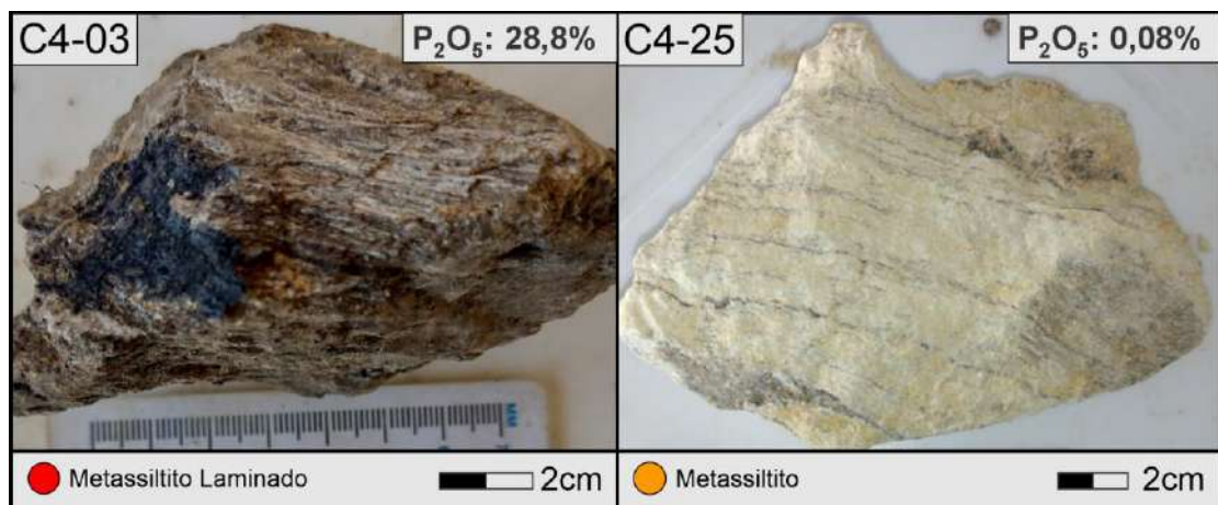
Figura 36 – Amostras de metassilito laminado com percolação de manganês e metassilito estéril.
