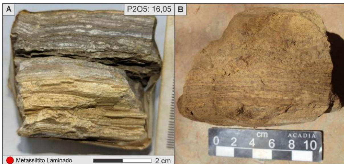
Figura 46 – A: Amostra de metassiltito laminado do depósito de Pratápolis; B: Amostra de Siltito microbiano do depósito de Campos Belos (Retirado de Carvalho, 2015)
