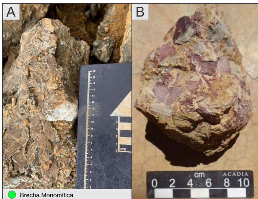
Figura 47 – A: Amostra de brecha monomítica do pit Ategina Sul no depósito de Pratápolis; B: Amostra de brecha intraformacional monomítica (Retirado de Carvalho, 2015).
