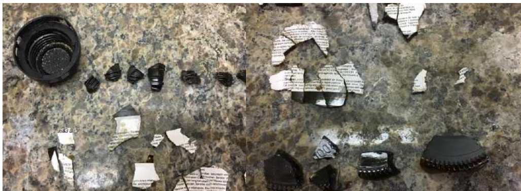
Figura 20 - Fragmentos do frasco utilizado no acidente Fonte: PEMM/COPPE/UFRJ (2018).
