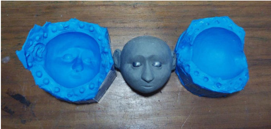
Imagem 14: Cabeça com seu molde bipartido em silicone.
