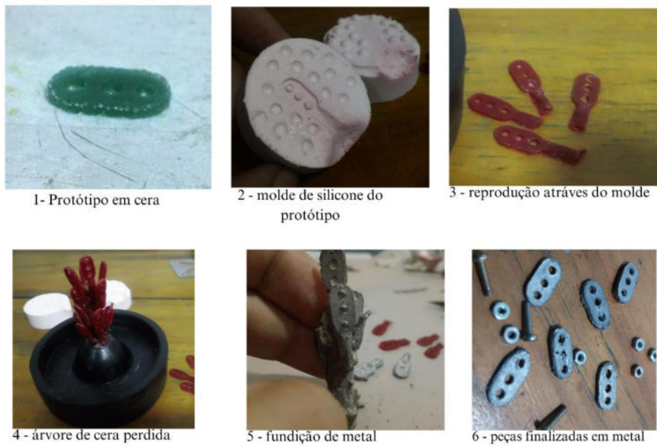
Imagem 11: Passo a passo da manufatura das articulações do boneco.
