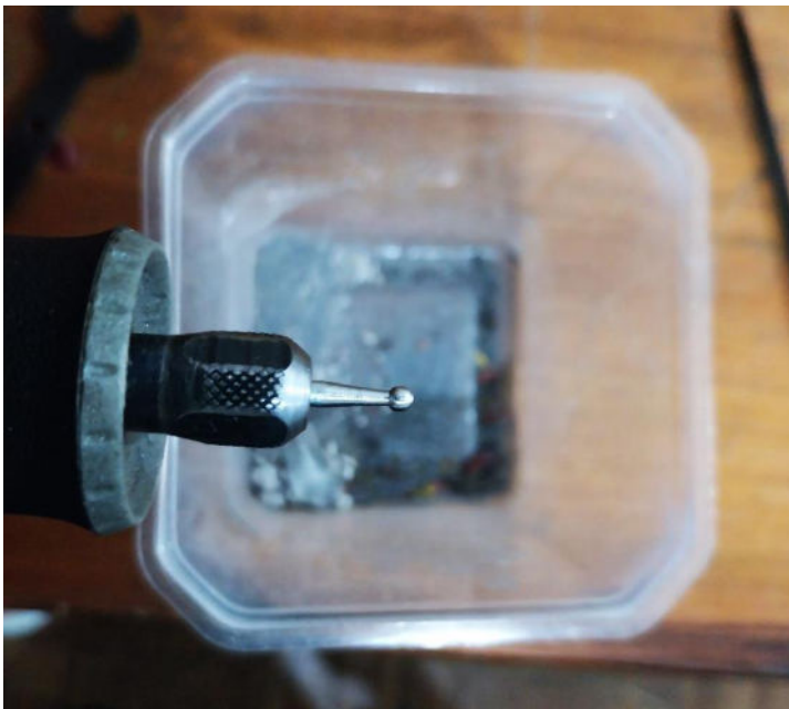
Imagem 10: extremidade esférica que será encaixada nas juntas móveis.
