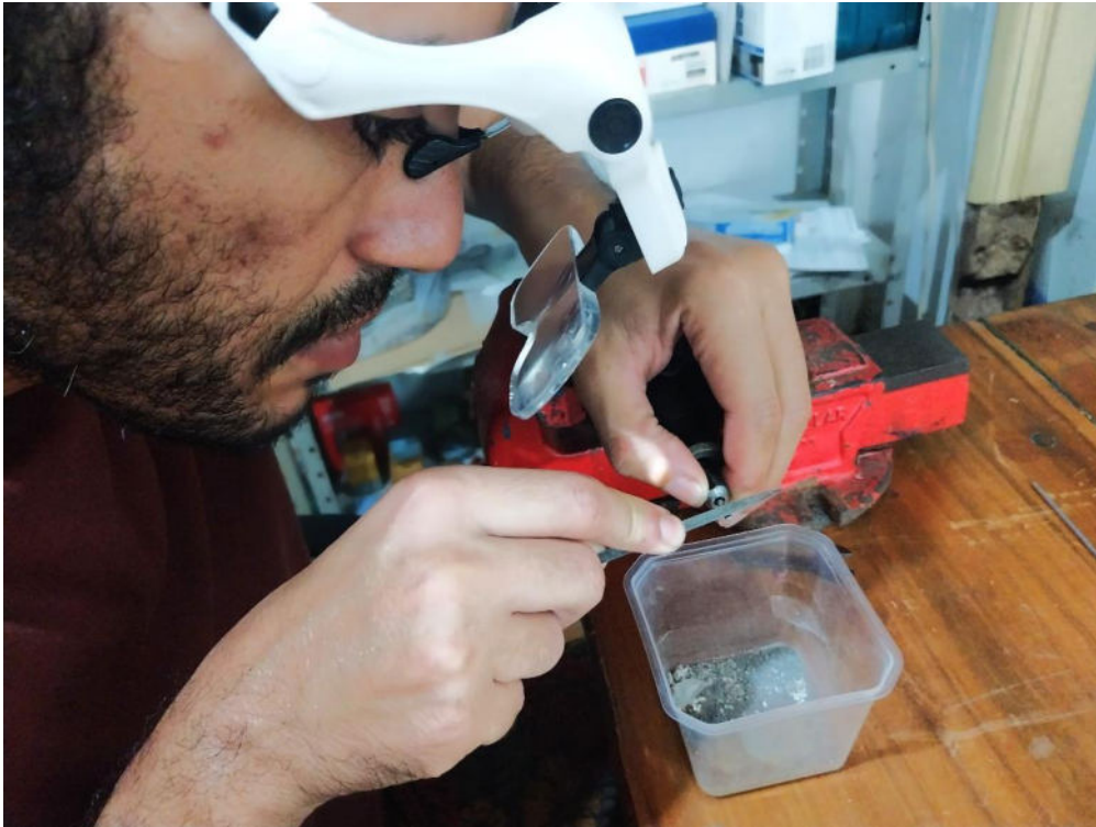
Imagem 9: esculpindo as esferas nas extremidades esféricas.
