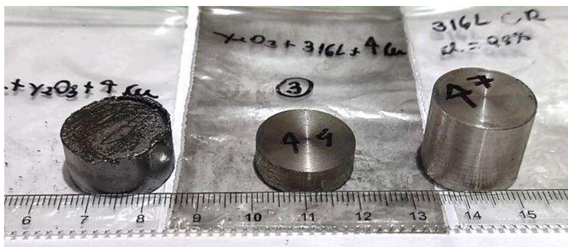
Figura 35 – Discos produzidos por SPS antes e após o torneamento para a remoção da folha de grafite.
