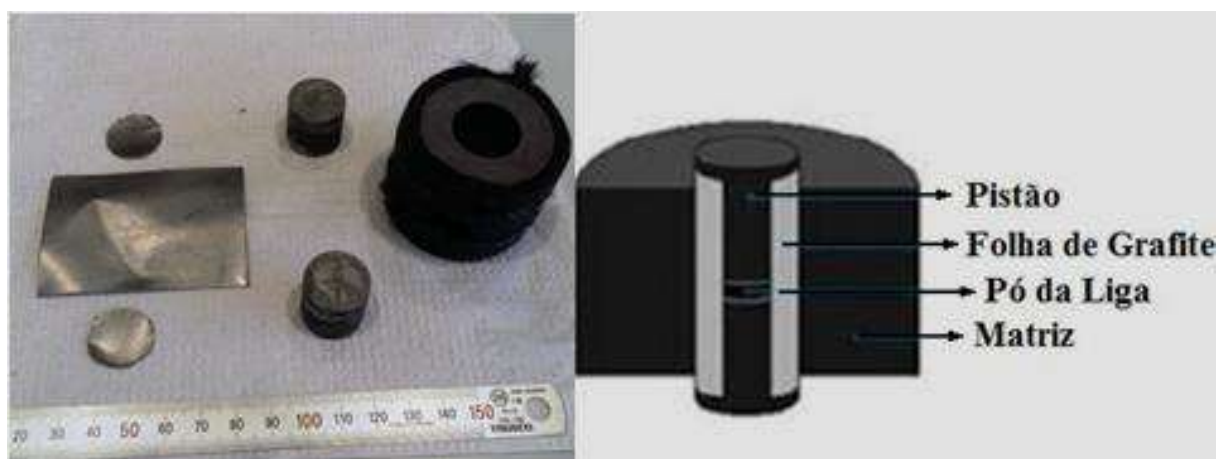
Figura 33 – Montagem da matriz utilizada no SPS .
