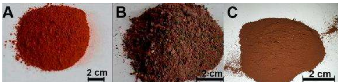
Figura 23. Aspecto visual da amostra antes (A) e depois da sulfatação seguida de tratamento térmico 1 e tratamento térmico (B) e do resíduo sólido depois da lixiviação (C). Condições: 50% de H_2SO_4 (m/m), 10% de H_2O , tratamento térmico 1: 265 °C por 60 min, tratamento térmico: 780 °C por 20 min e lixiviação: 80 °C, 12,5% de sólidos, 30 min.
