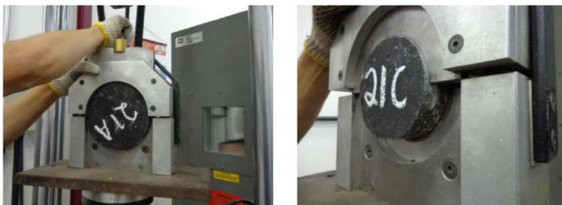
Figura 4. Ensaio de cisalhamento de mistura asfáltica em equipamento do tipo Leutner .
