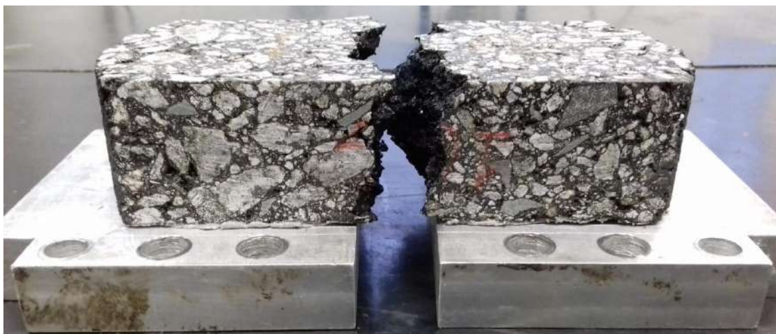
Figura 39. Ruptura total de amostra do ensaio OT.
