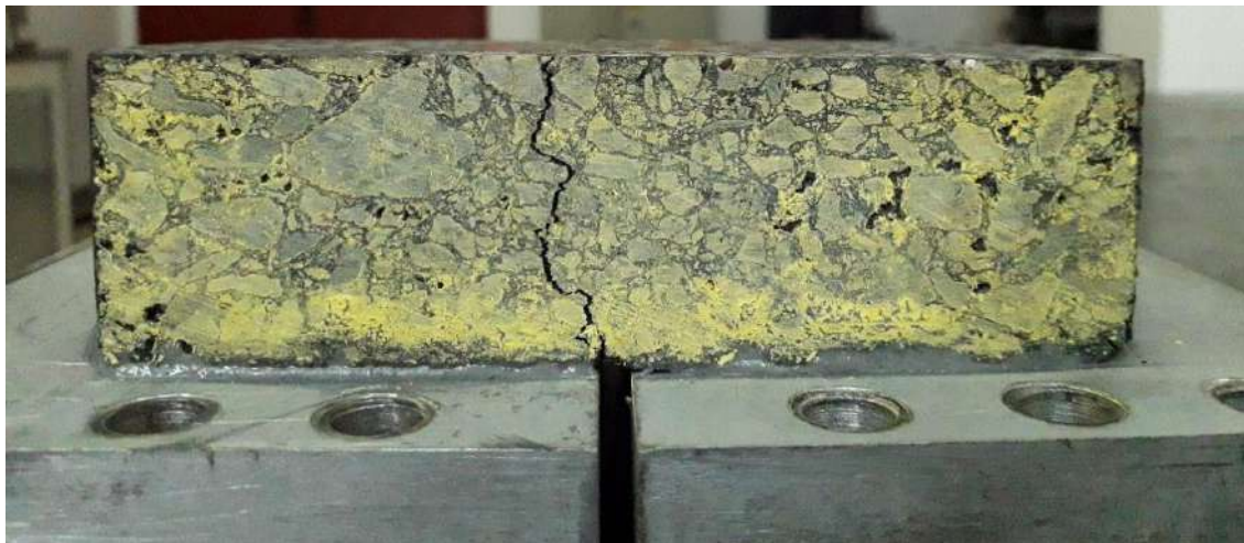
Figura 38. Detalhe da macro trinca formada nas amostras do ensaio OT.
