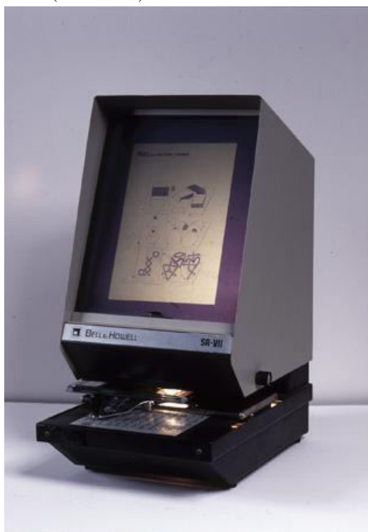
Figura 14 – Artemicro, Impressão gelatina e sais diazóticos sobre base poliéster – filme DIAZO (microficha) e leitor de microficha Bell & Howell.
