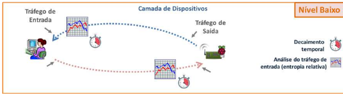
Figura 3.3: Exemplo de uso do Nível Baixo: cada dispositivo constrói sua confiança conforme a entropia relativa do tráfego recebido do dispositivo comunicante. O decaimento temporal da confiança se dá após um período de ociosidade ou desconexão dos dispositivos em termos de tráfego
