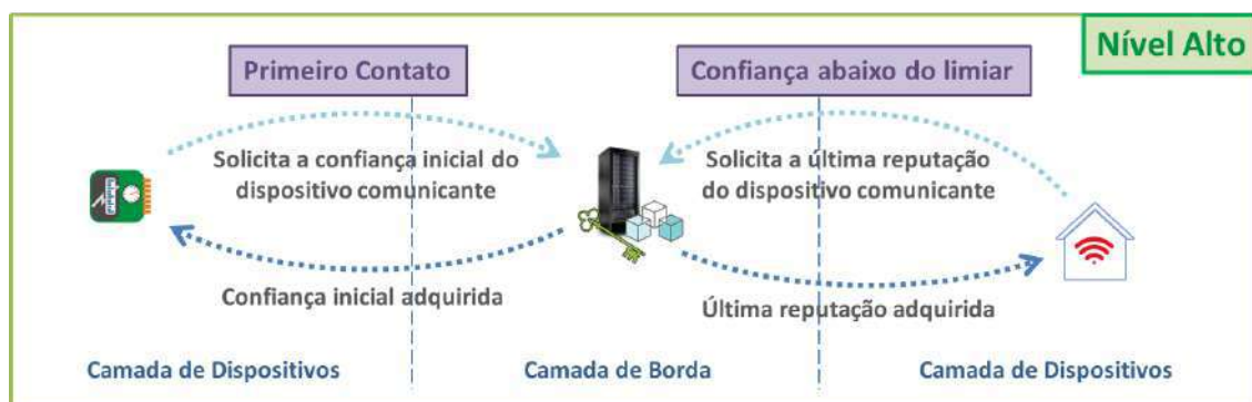
Figura 3.2: Uso do Nível Alto: (i) quando o primeiro contato é estabelecido e um valor de confiança inicial precisa ser adquirido; (ii) quando o valor de confiança é reduzido a um patamar abaixo de um limiar mínimo de confiança predefinido
