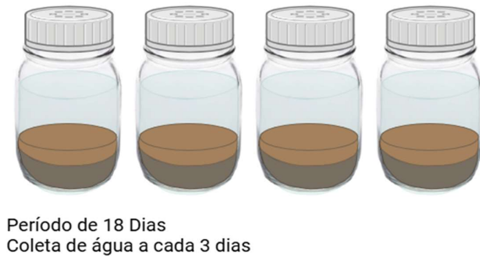
Figura 7 - Esquema representativo do ensaio. Montagem de quatro potes de 2L contendo uma mistura de água destilada, substrato comercial e areia na proporção 2:1 conforme Zandonadi et al. (2019). O experimento foi mantido por 18 dias, com coletas de amostras de água realizadas a cada 3 dias para análise posterior da fertilidade.
