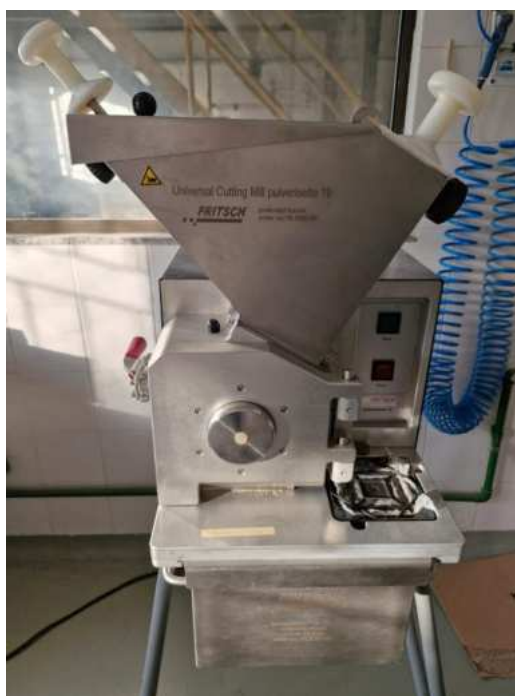
Figura 23 - Moinho de facas modelo Pulverisette P-19 (Fritsch, Alemanha), localizado no Laboratório Bioetanol na UFRJ
