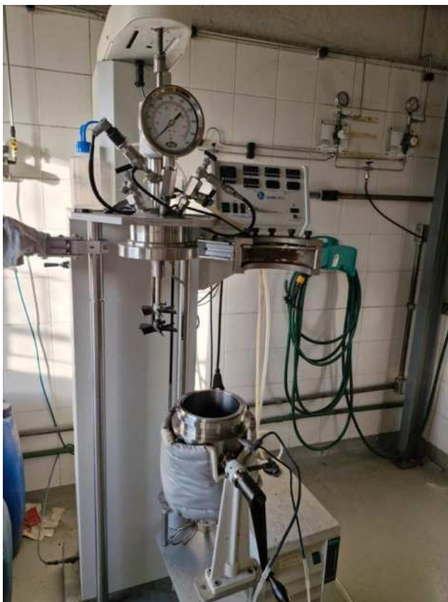
Figura 25 - Reator Parr modelo 4848B, localizado no Laboratório Bioetanol na UFRJ
