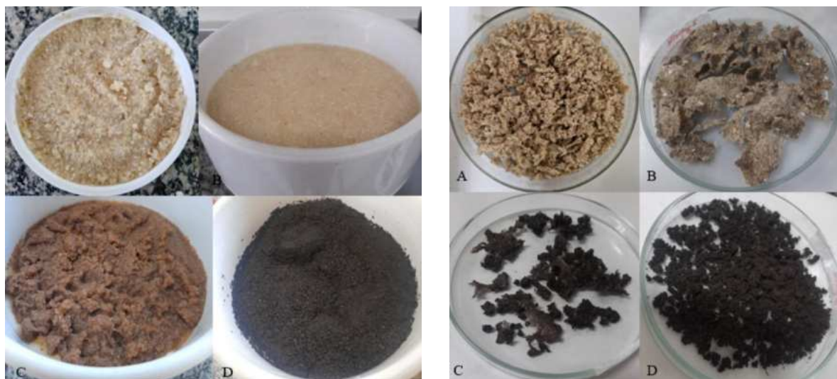
Figura 30 - Frações sólidas úmidas do bagaço de laranja pré-tratado hidrotermicamente a 70°C (A), 100°C (B), 140°C (C) e 180°C (D), à esquerda. Frações sólidas secas do bagaço de laranja pré-tratado hidrotermicamente a 70°C (A), 100°C (B), 140°C (C) e 180°C (D), à direita.
