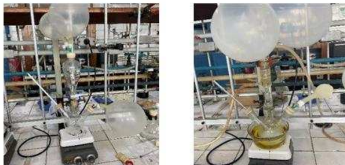
Figura 4. Etapas da síntese dos HDL em atmosfera inerte: (a) adição e (b) aquecimento.
