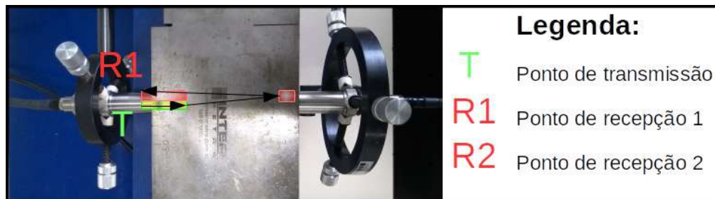
Figura 3.1: Representação do arranjo de aquisição seguindo o método 1T2R .
