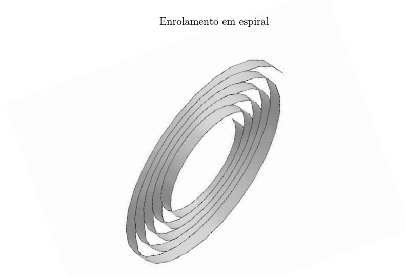
Figura 6.2: Ilustração do enrolamento em espiral usado em proposta de máquina da parceria UFRJ/UFF/CEPEL. Figura fora de escala.
