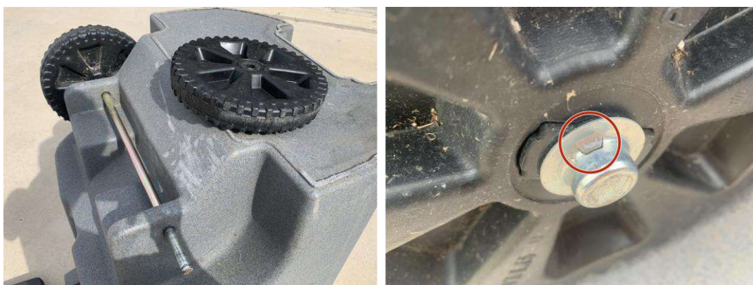
Figura 134 - Análise de sistema de eixo de rotação de container de lixo.
