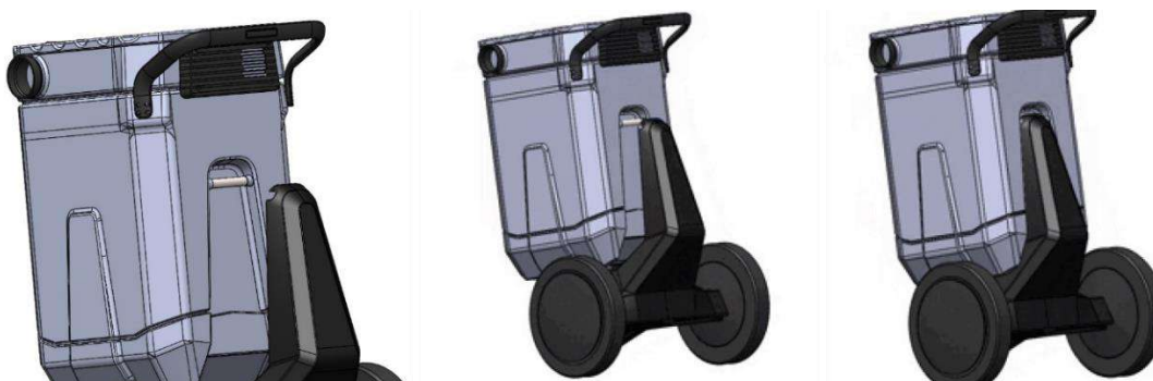
Figura 132 - Demonstração do encaixe do suporte no container.
