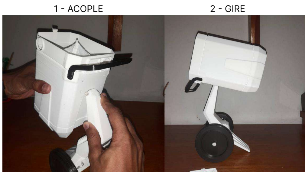
Figura 102 - Teste de equilíbrio e centro de massa com impressão 3D. Fonte: Elaboração Própria.
