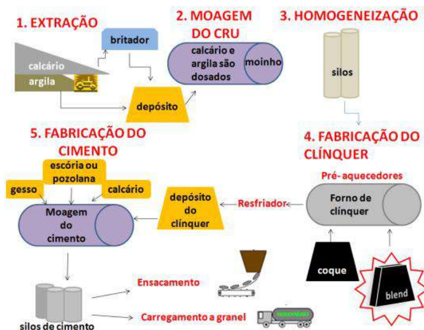
Figura 11: Esquema simplificado de funcionamento de uma indústria cimenteira. Coprocessamento ocorre durante a produção de clínquer, ao introduzir o blend .
