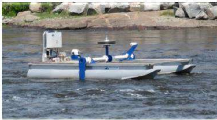
Figura 0.5. Exemplo de turbina de fluxo cruzado com ancoragem flutuante.
