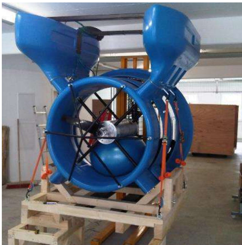
Figura 0.6. Exemplo de turbina de fluxo axial com ancoragem flutuante.
